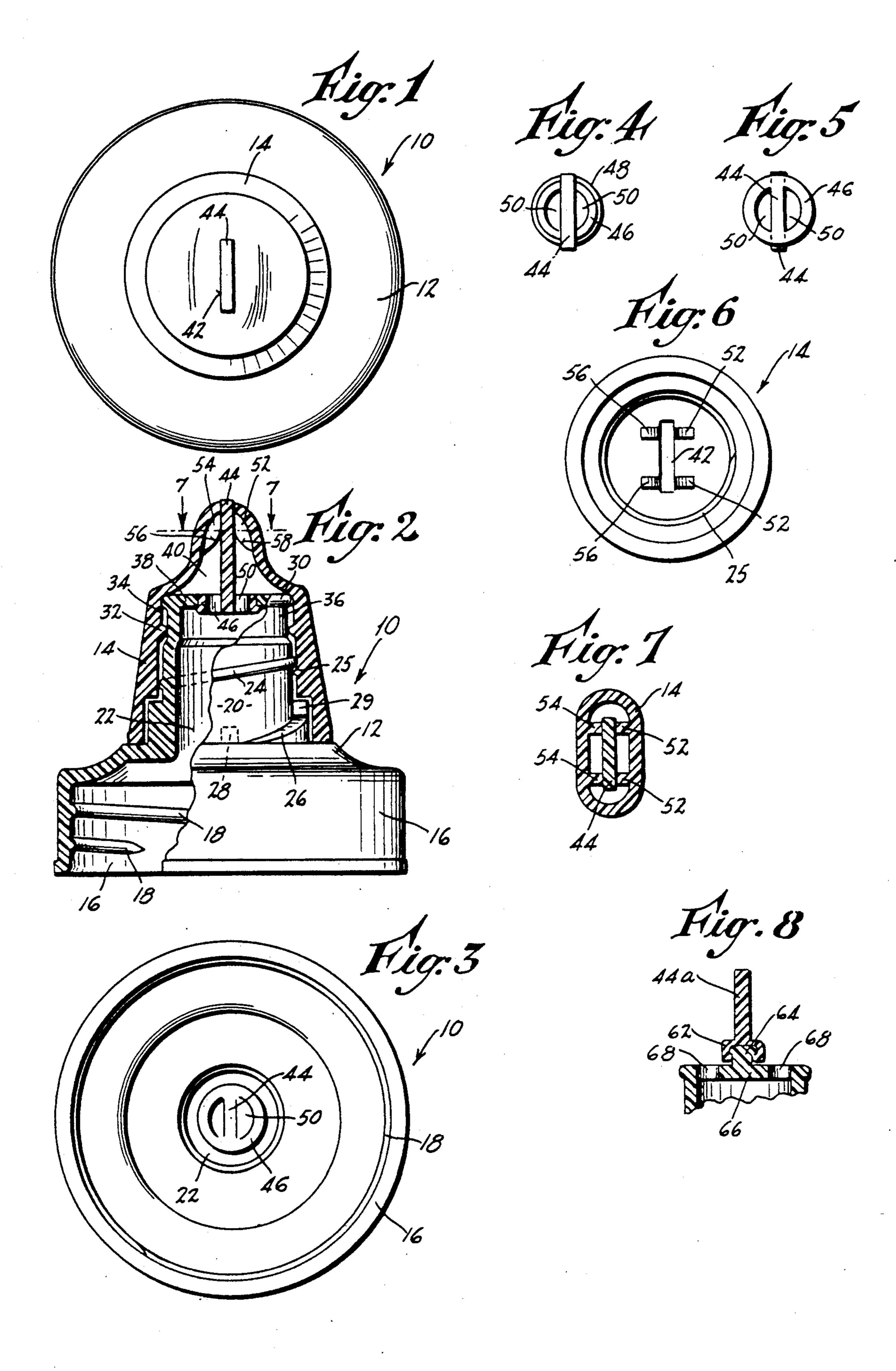
RIBBON-TYPE DISPENSING CAP HAVING AN AXIAL CLOSURE BLADE THAT ROTATES ALONG WITH AN OUTER APERATURED CAP BUT REMAINS LONGITUDINALLY STATIONARY 5
