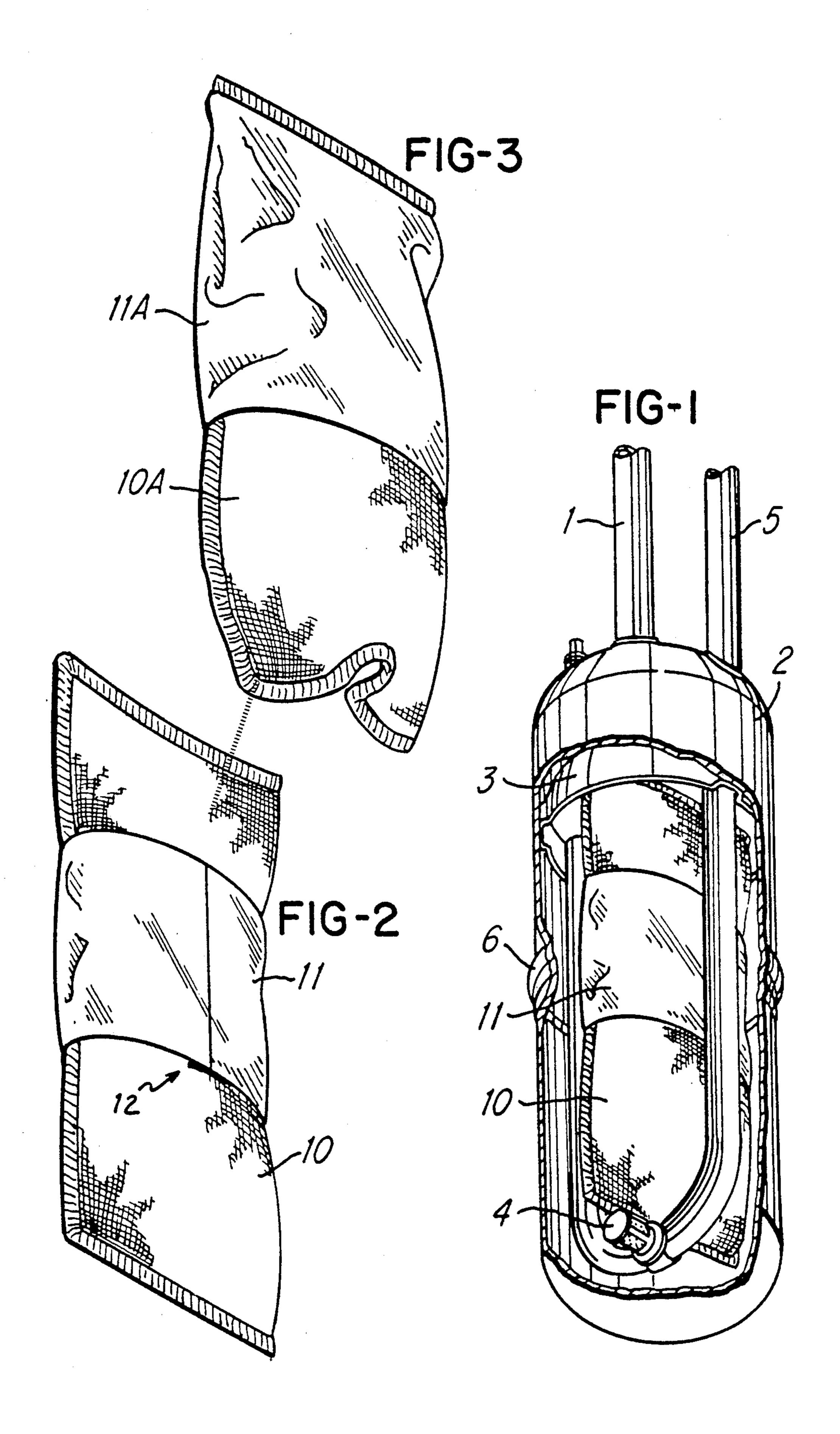
ADSORBENT PACKAGE THAT IS RESISTANT TO HIGH TEMPERATURE
