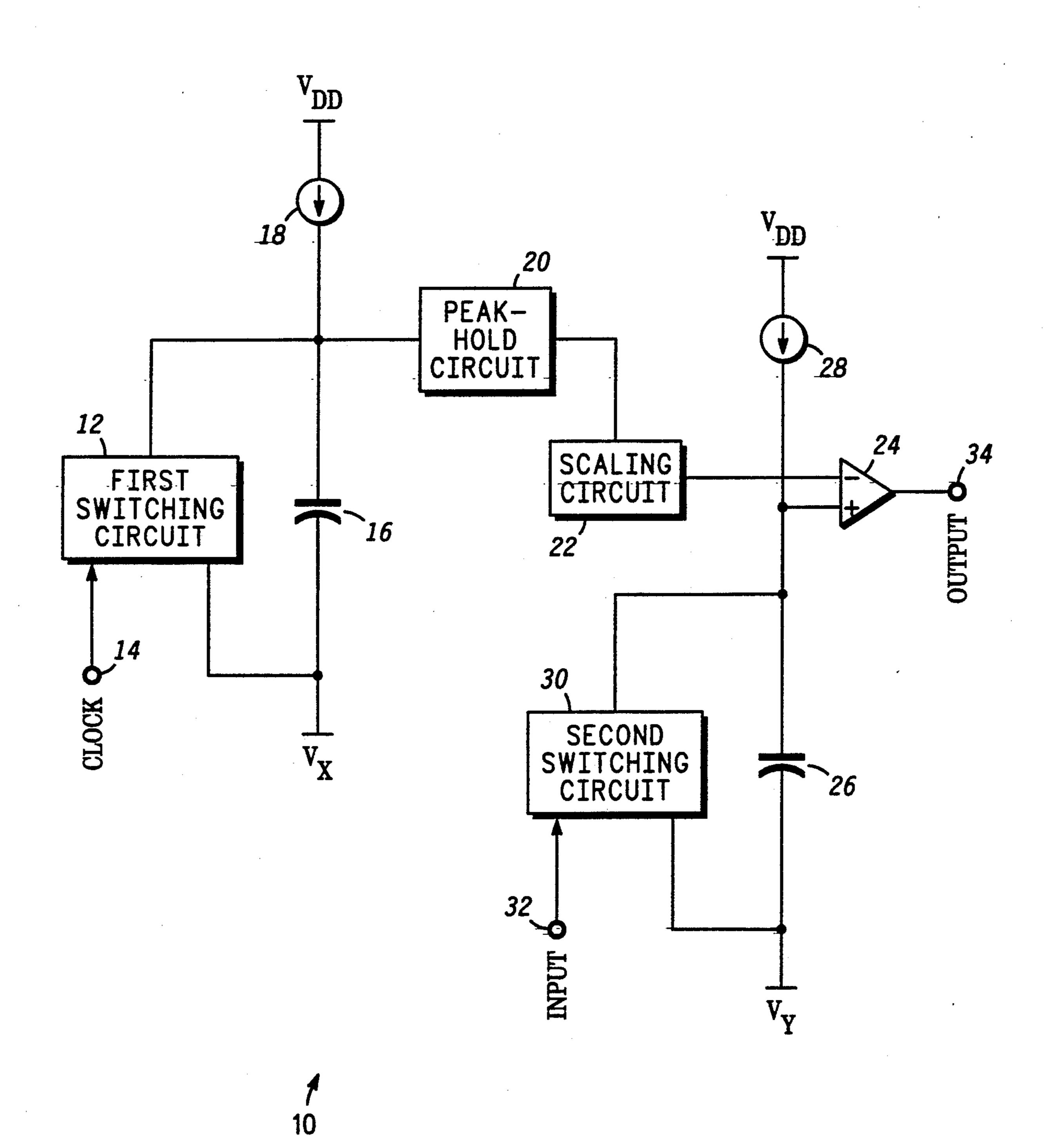
ASYNCHRONOUS DELAY CIRCUIT
