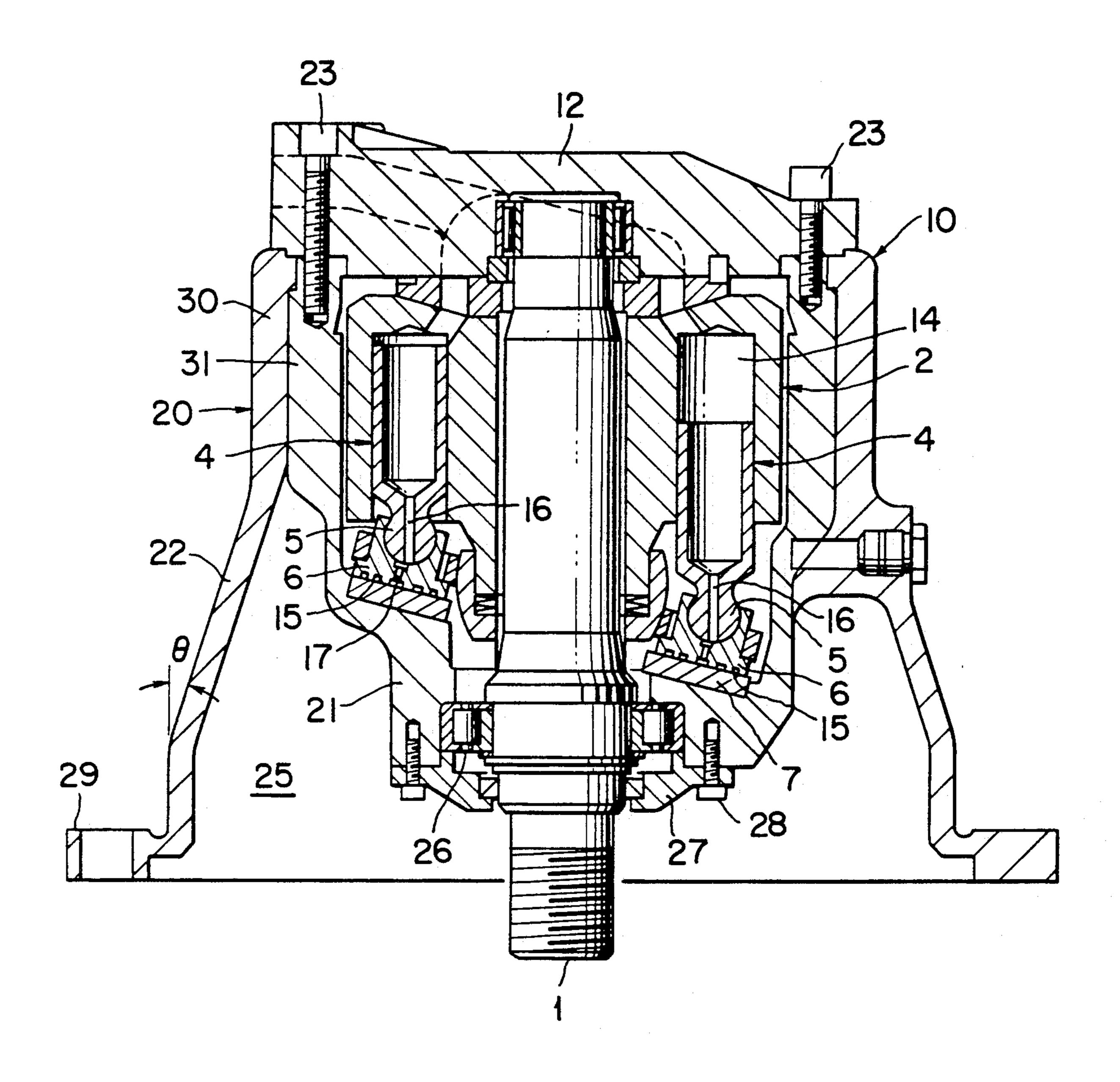
SWASH-PLATE TYPE PISTON PUMP MOTOR
