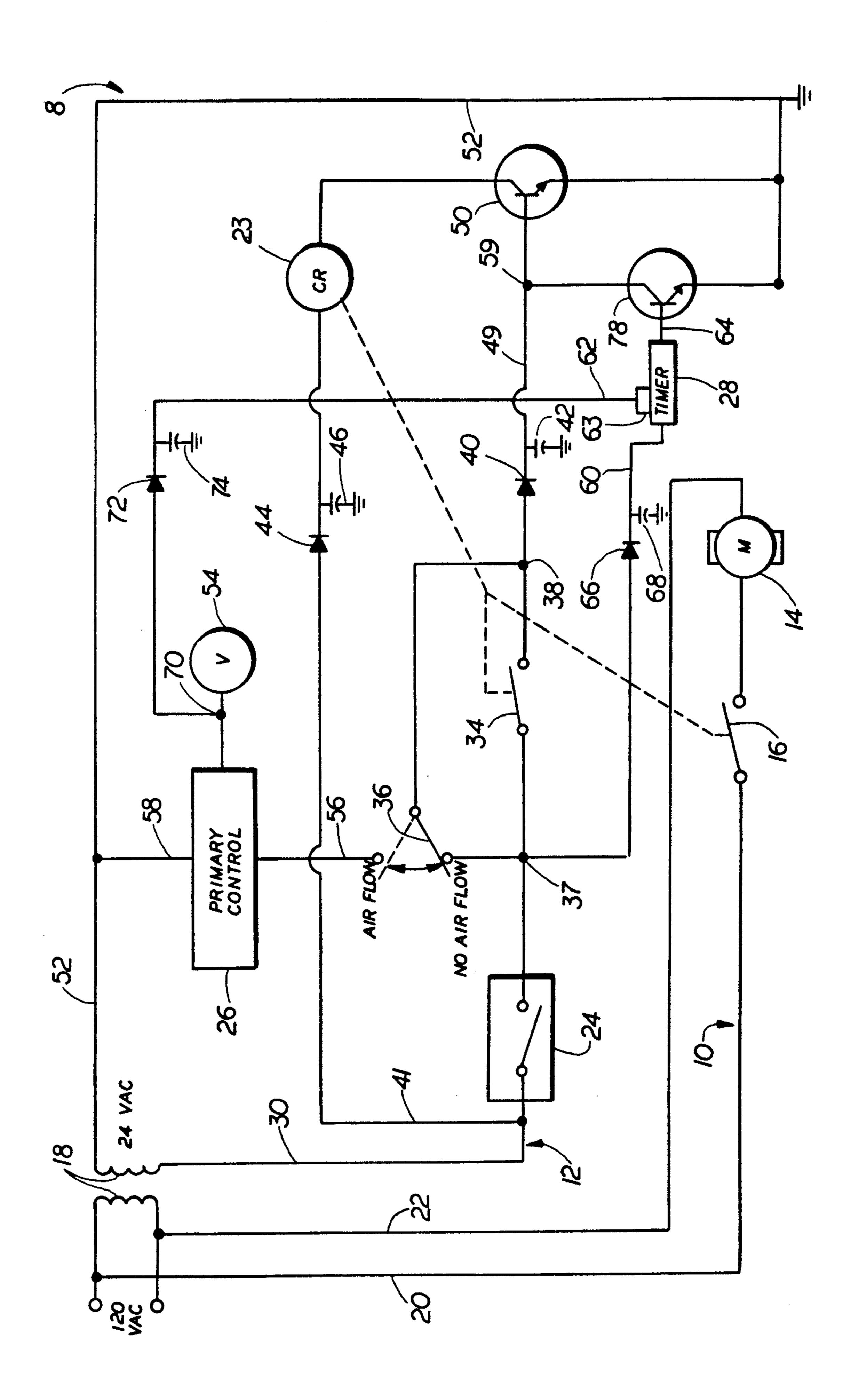
TIME-DELAY CIRCUIT FOR AUTOMATIC SHUTDOWN OF FURNACE SYSTEMS
