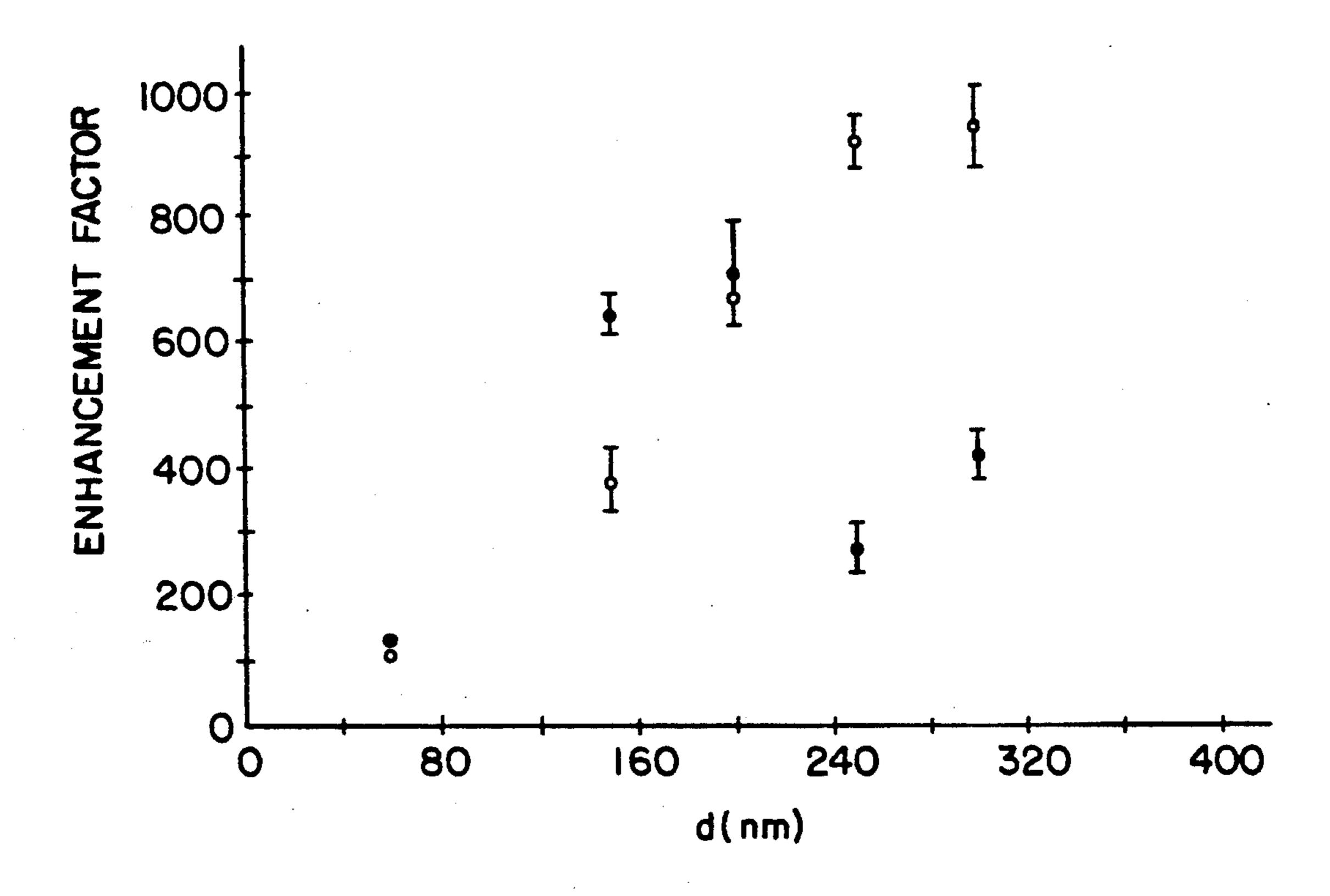
FIG.4 ENHANCEMENT FACTORS VS. WAVEGUIDE THICKNESS & OF THE TM-POLARIZED RESONANT FLUORESCENT SIGNAL EMITTED BY THE SURFACE PLASMON MODE. THE SOLID DOTS DENOTE THE ENHANCEMENT FACTORS FOR TM-POLARIZED EXCITING LIGHT, THE CIRCLES DENOTE THE ENHANCEMENT FACTORS FOR TE-POLARIZED EXCITING LIGHT.
