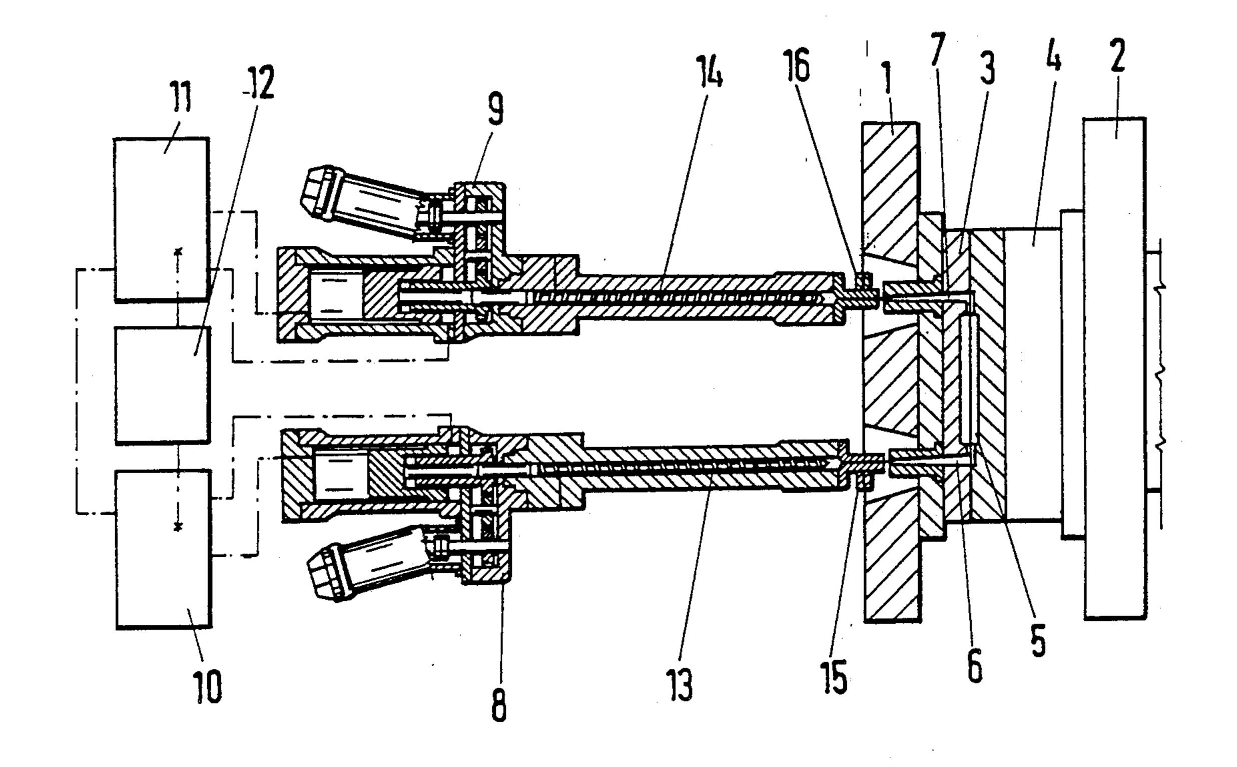
PROCESS FOR INJECTION MOLDING OF INJECTION MOLDED PARTS OF PLASTICIZED LIQUID CRYSTAL POLYMER MATERIAL
