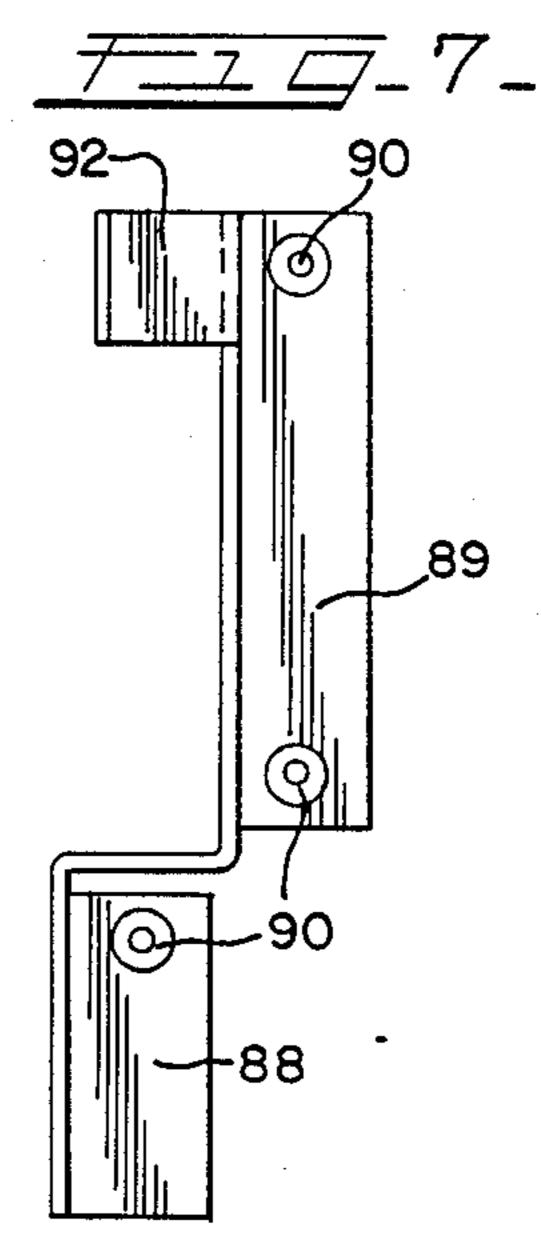
ALIGNING BRACKET FOR A CIRCUIT BOARD IN
