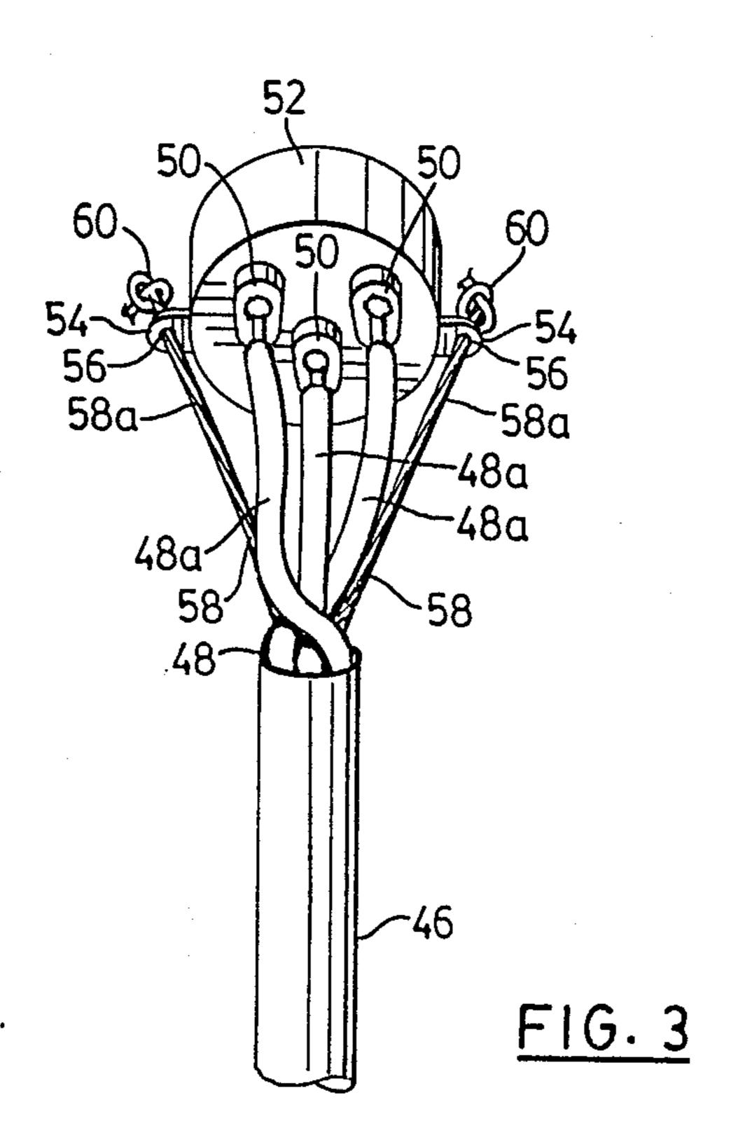
STRAIN RELIEF SYSTEM FOR CONNECTING CABLES
