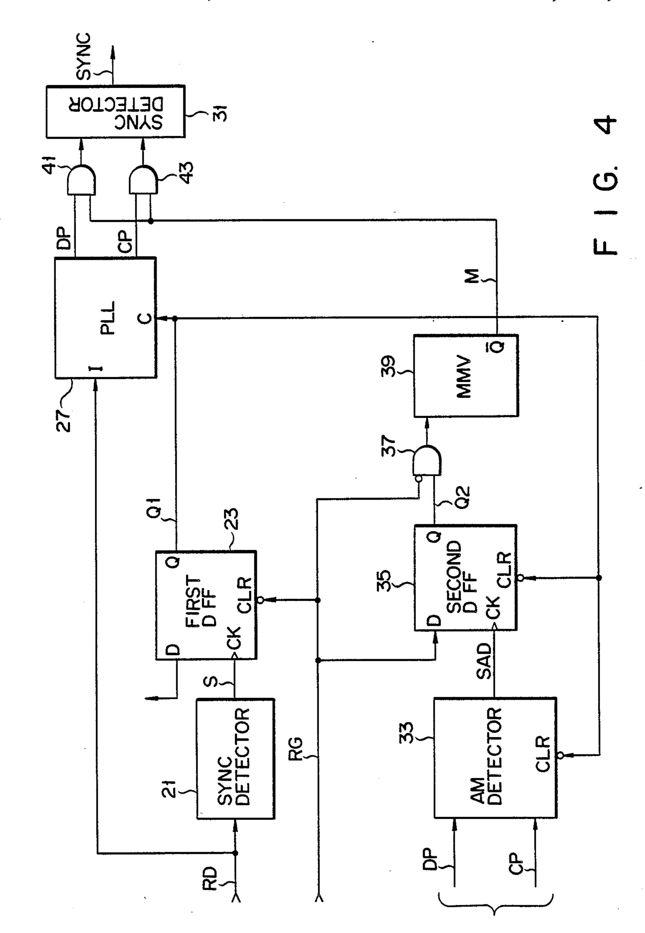
RECORDING/REPRODUCING SYSTEM FOR A MAGNETIC RECORDING MEDIUM INCLUDING SYNCHRONIZATION DETECTING CIRCUIT
