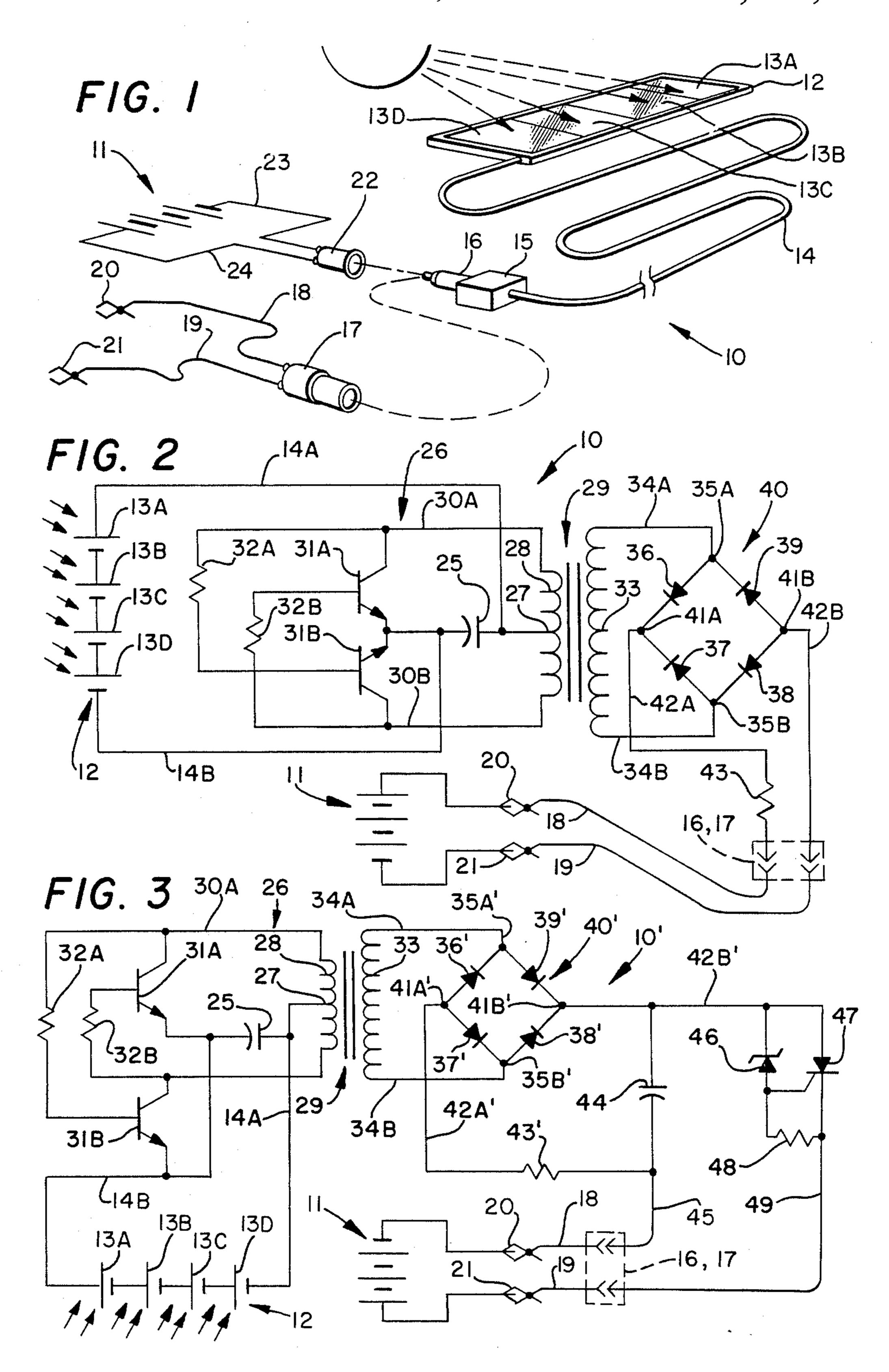
SOLAR TRICKLE CHARGER FOR LEAD ACID **BATTERIES**
