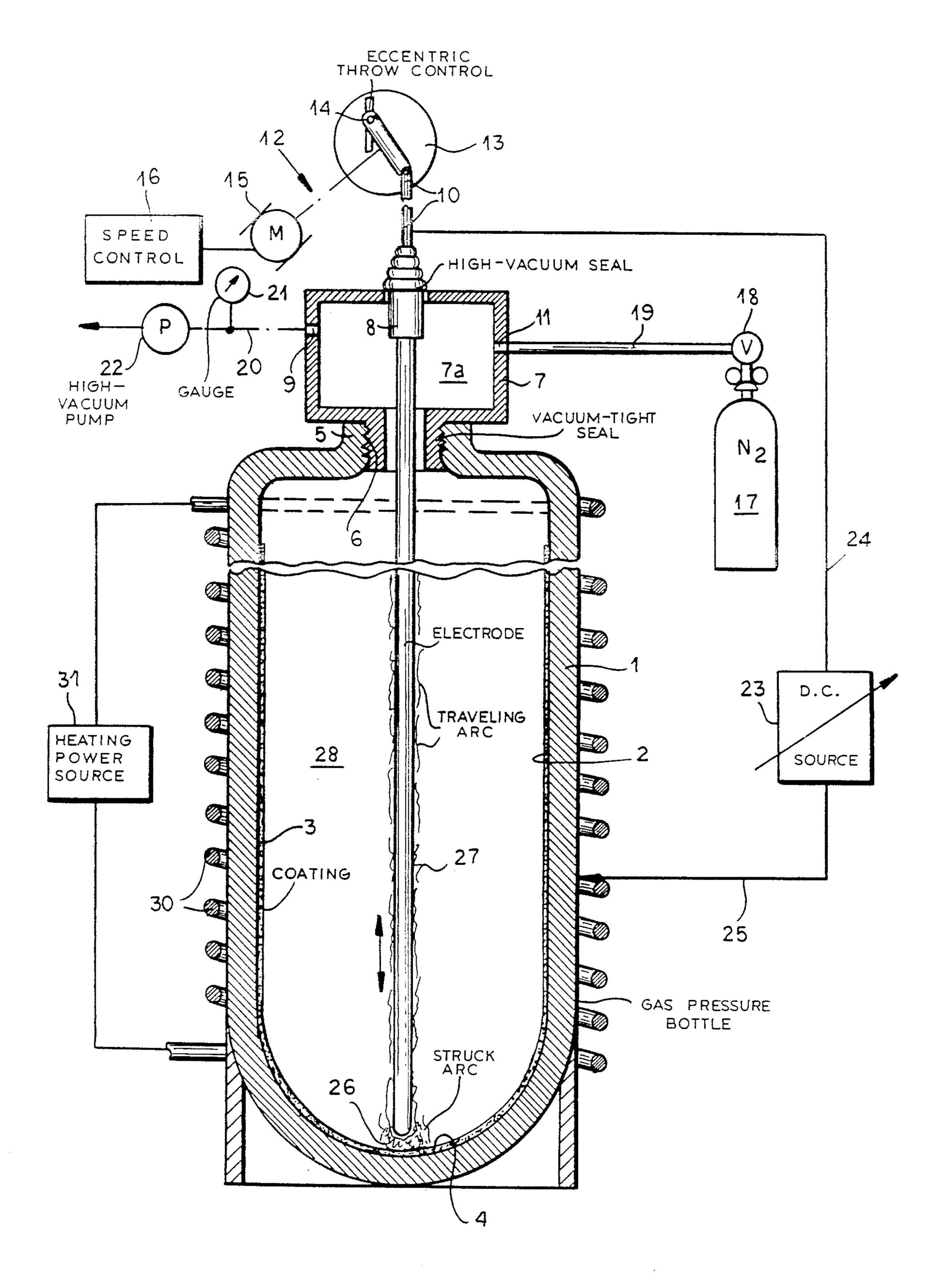
APPARATUS FOR COATING A METAL GAS-PRESSURE BOTTLE OR TANK
