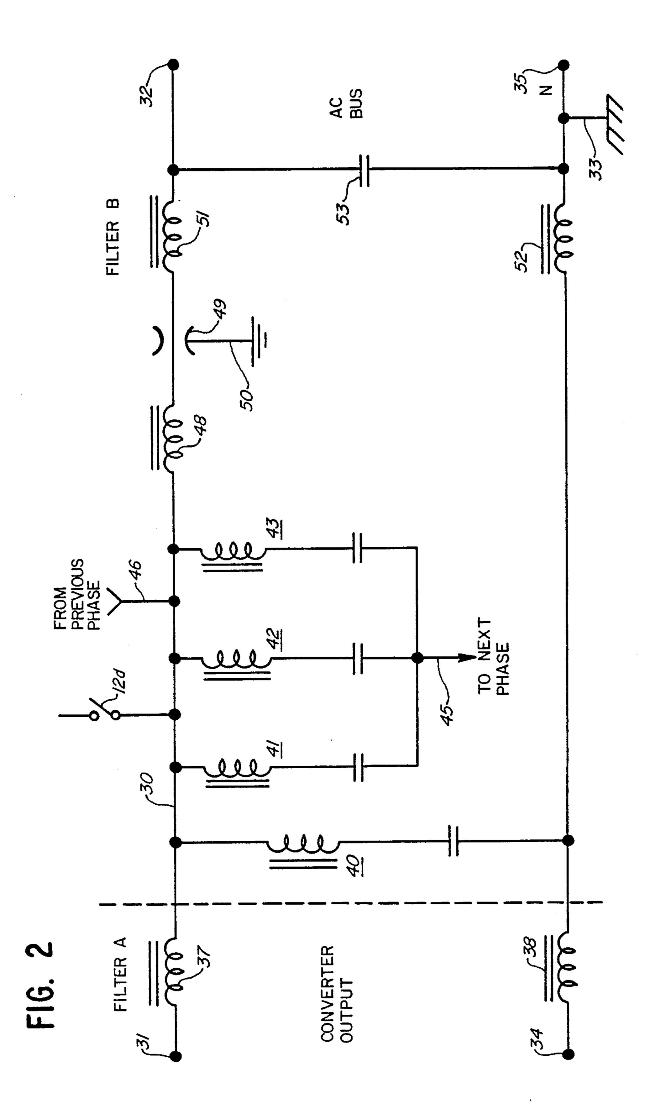
FILTER FOR VARIABLE SPEED, CONSTANT FREQUENCY ELECTRICAL SYSTEM
