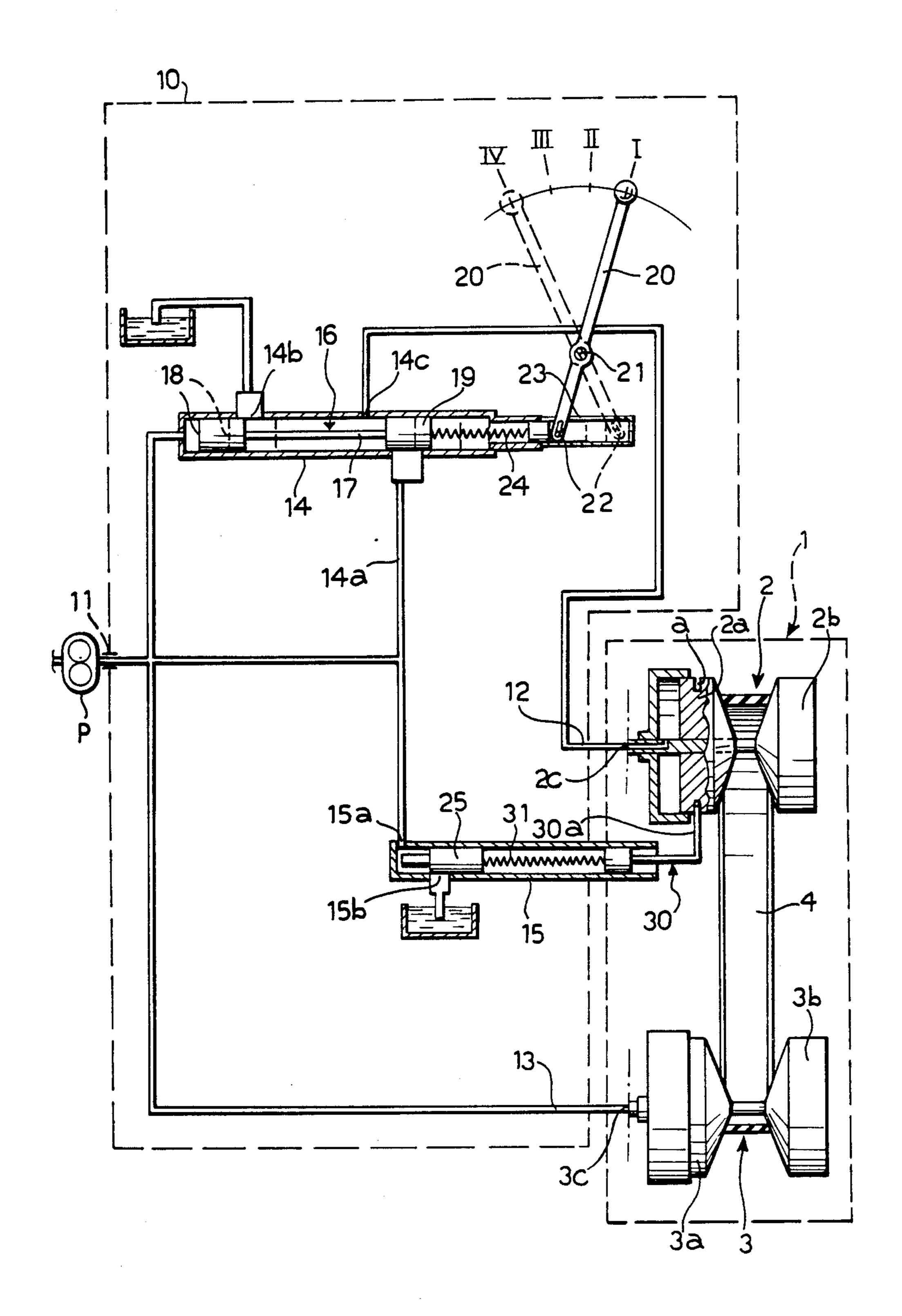
MANUALLY-OPERATED CONTROL DEVICE FOR A MOTOR VEHICLE GEARBOX COMPRISING A
