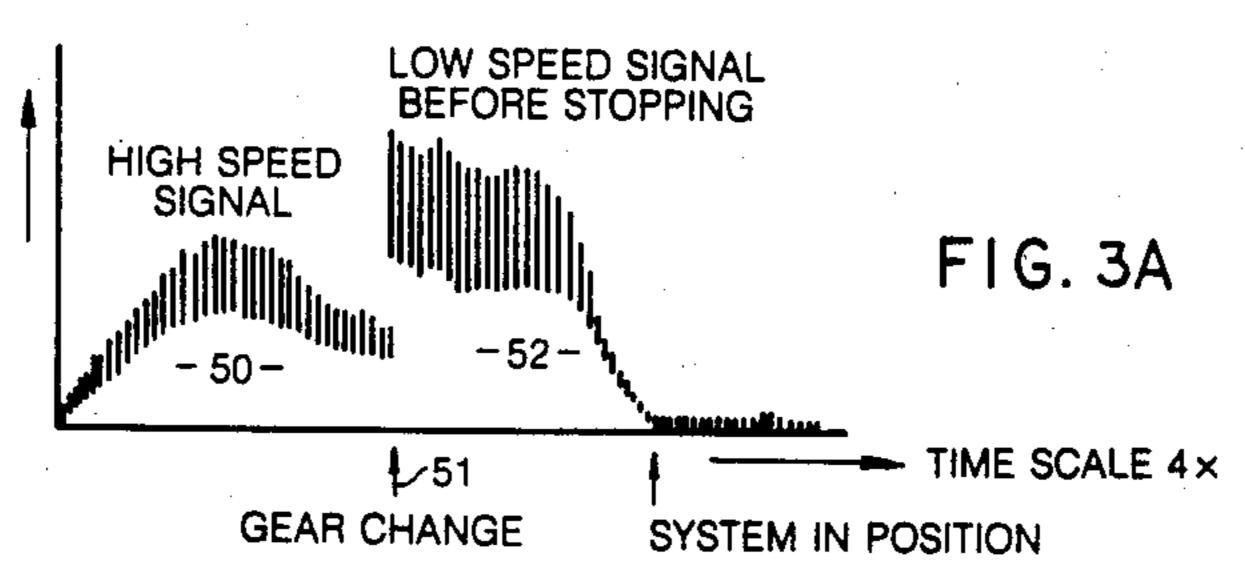
TACHOMETER SIGNAL FOR NORMAL PRINTING DISTANCE, SHOWING THE HIGH LEVEL SIGNAL
