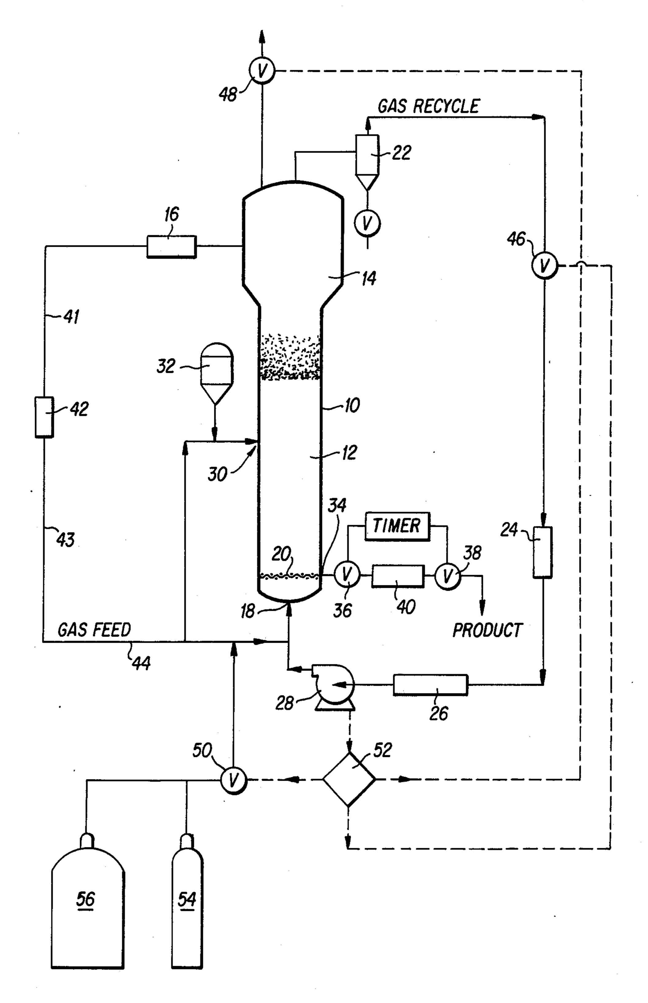
METHOD AND REACTOR SYSTEM FOR RAPID KILL GAS INJECTION TO GAS PHASE POLYMERIZATION REACTORS
