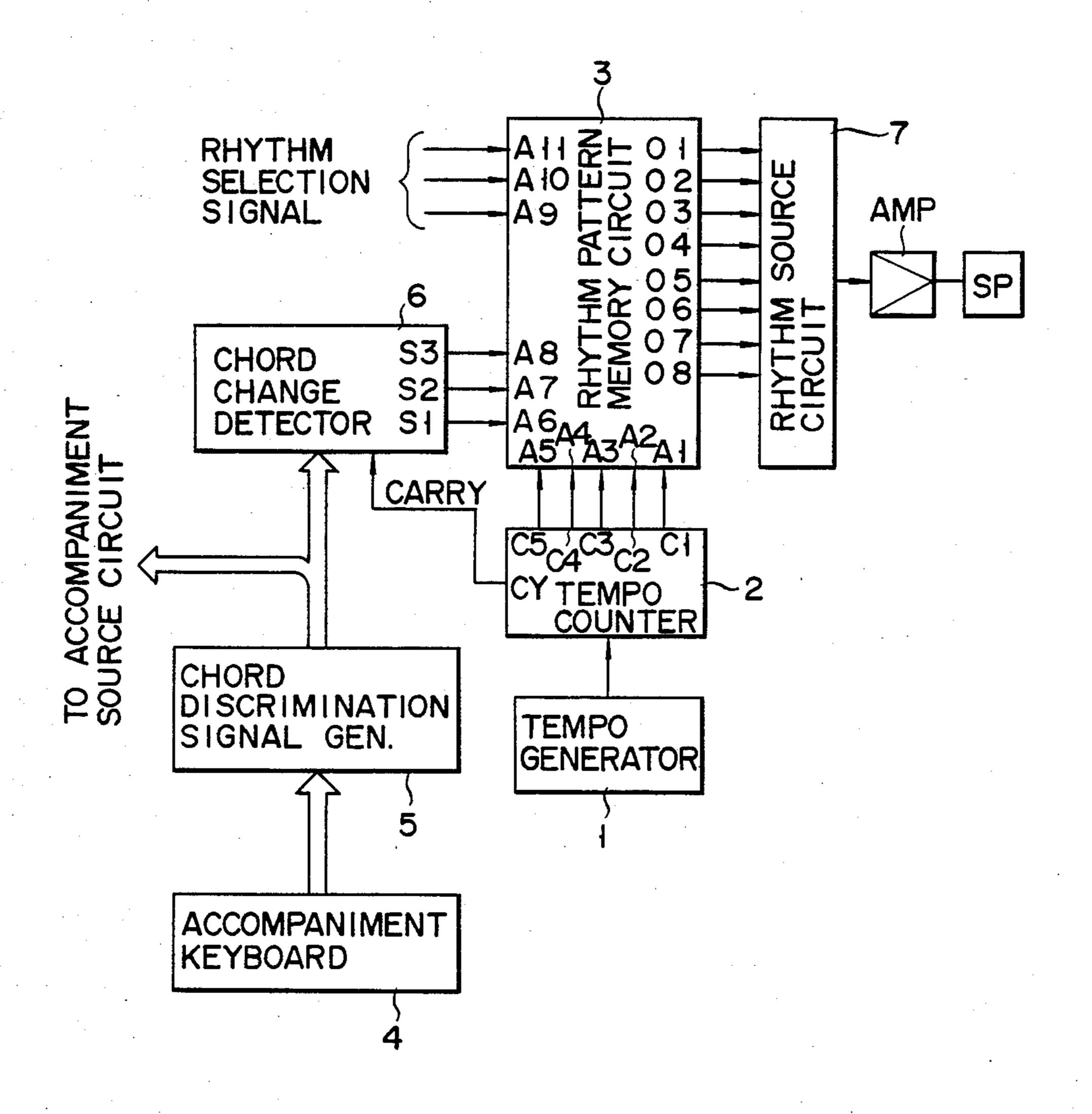
U.S. Patent 4,656,911 Sheet 2 of 6 Apr. 14, 1987 CIRCUIT **WEWOKA** CHORD CHANGE COMPARATOR WS
