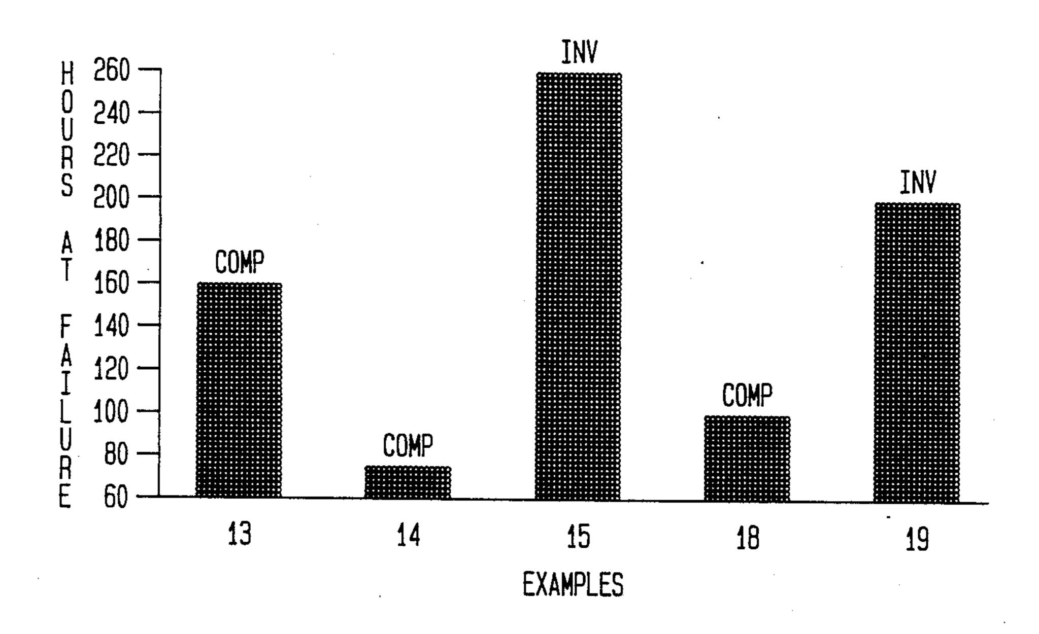
FIG. 1 XENON WEATHEROMETER COMPARISON OF UNPIGMENTED SYSTEMS
