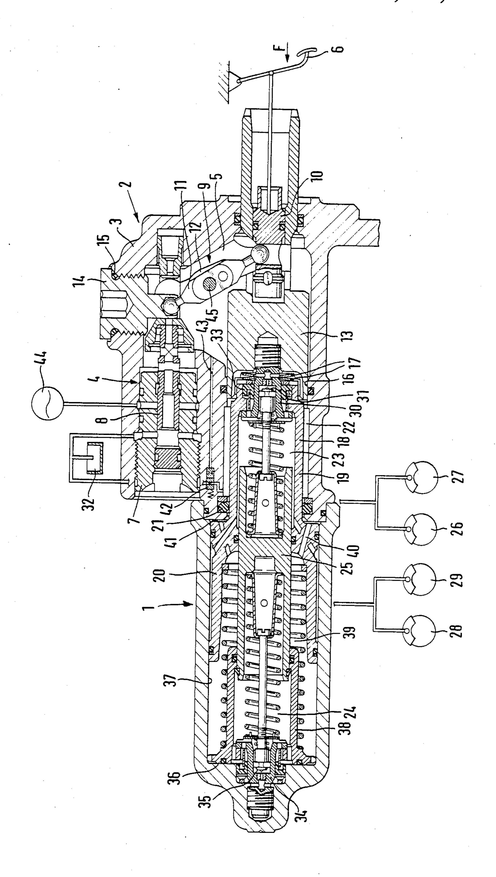
BRAKE-PRESSURE GENERATOR HAVING AN IMPROVED MASTER CYLINDER AND BOOSTER FOR AN AUTOMOTIVE HYDRAU-LIC BRAKE SYSTEM
