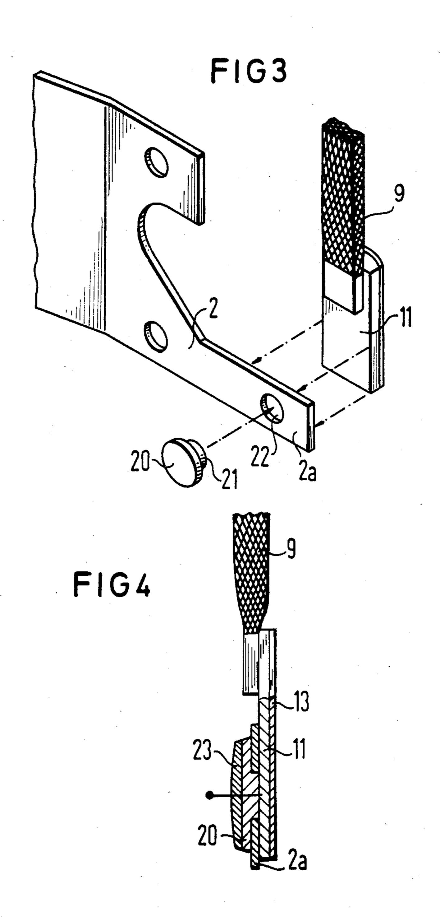
CONTACT ARRANGEMENT FOR A HIGH BREAKING CAPACITY RELAY
