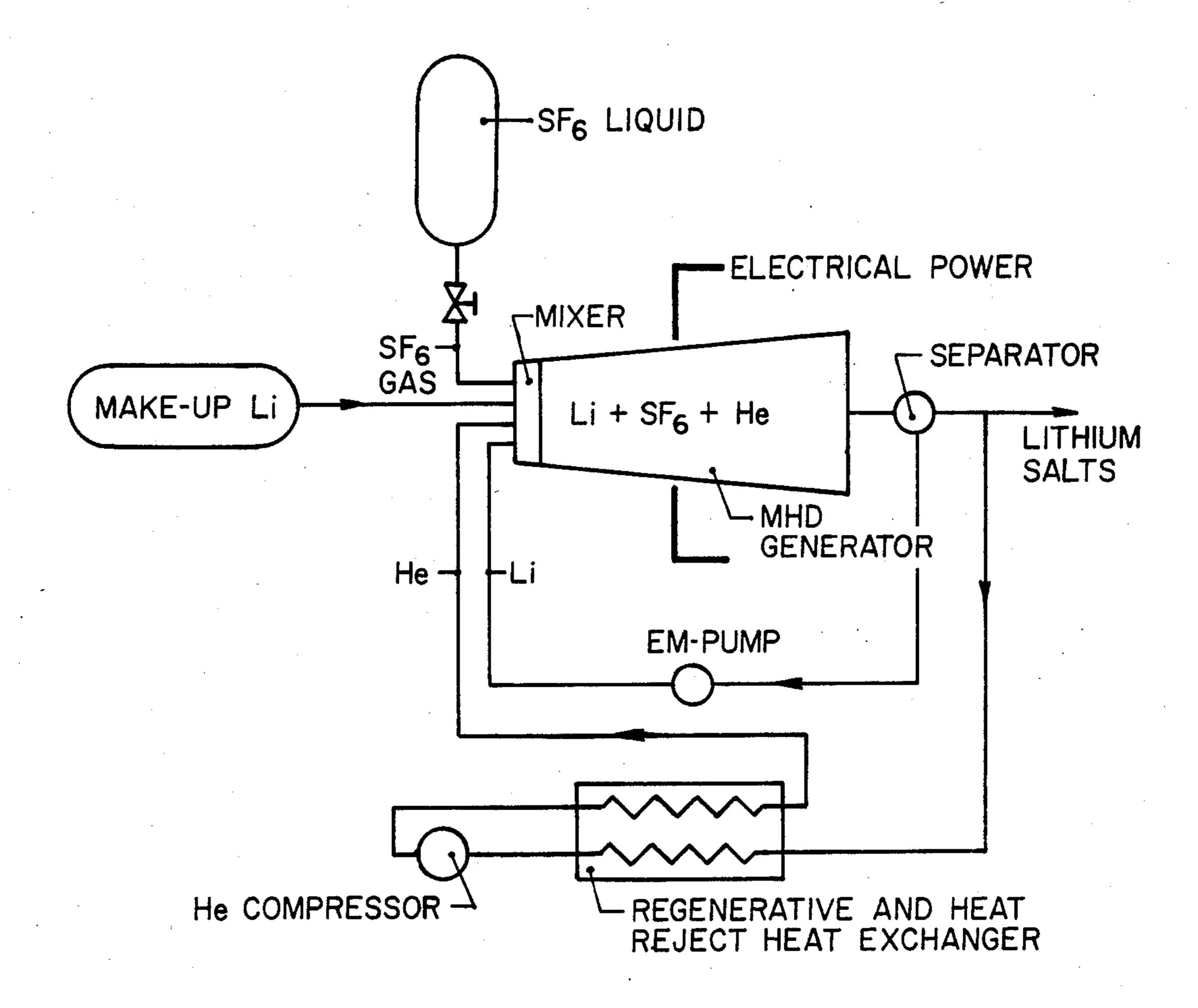
LITHIUM-SULFUR HEXAFLUORIDE MAGNETOHYDRODYNAMIC POWER CYCLE
