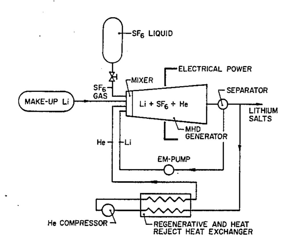
LITHIUM-SULFUR HEXAFLUORIDE MAGNETOHYDRODYNAMIC POWER CYCLE
