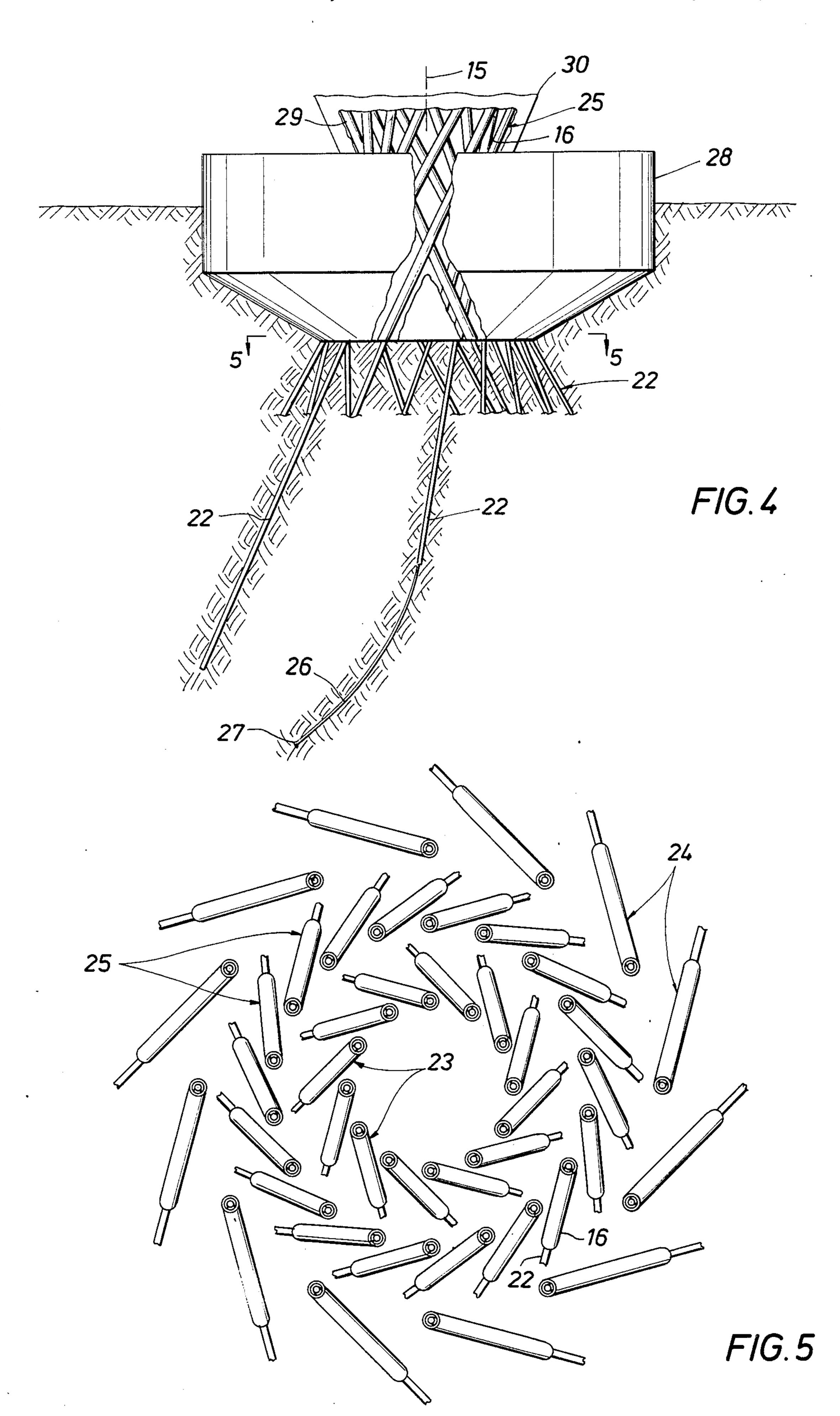
**BUOYANT TOWER FLEXURE JOINT**
