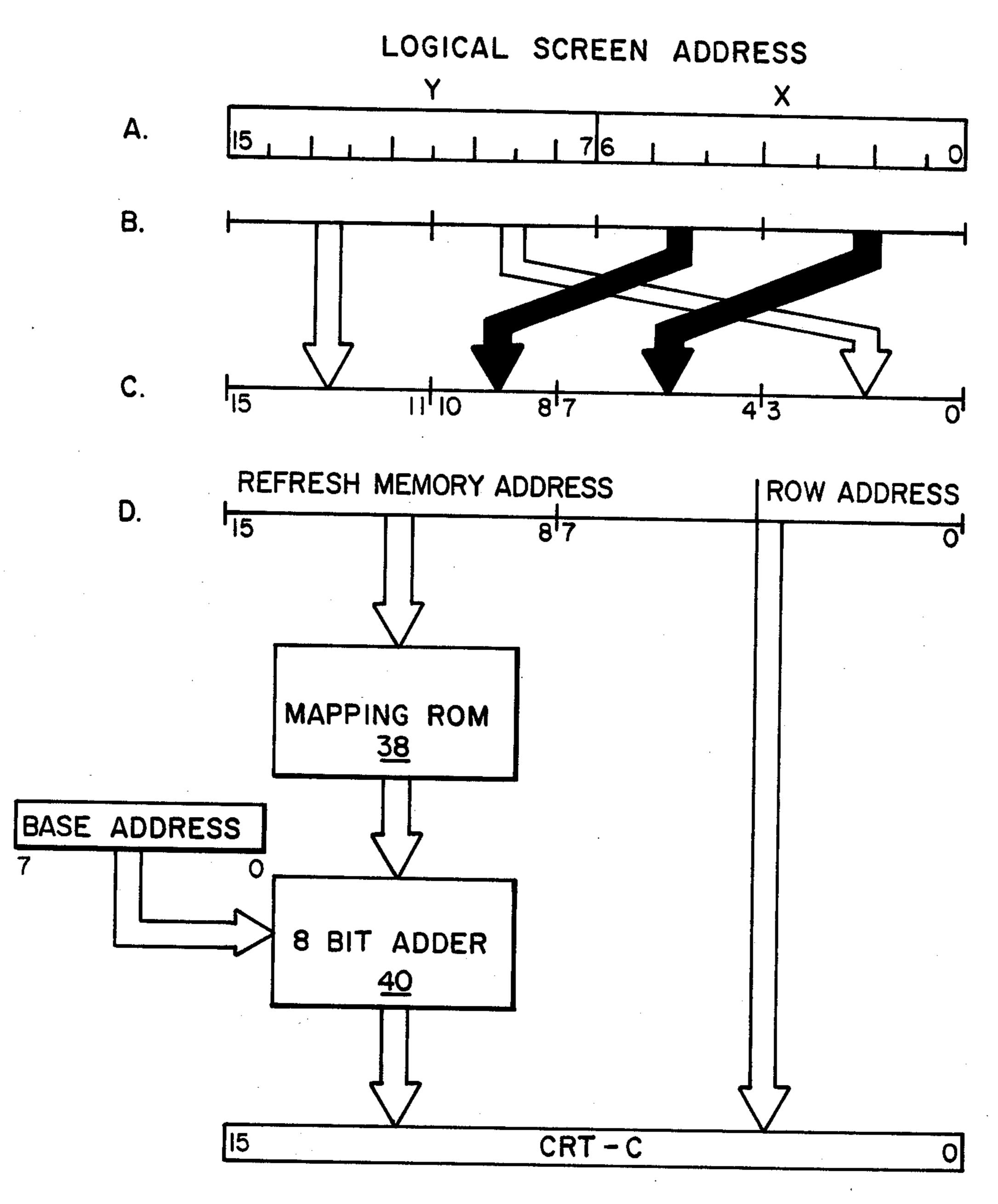
X = HORIZONTAL BYTE INDEX (0, 127) Y = VERTICAL BYTE INDEX (0, 511)
