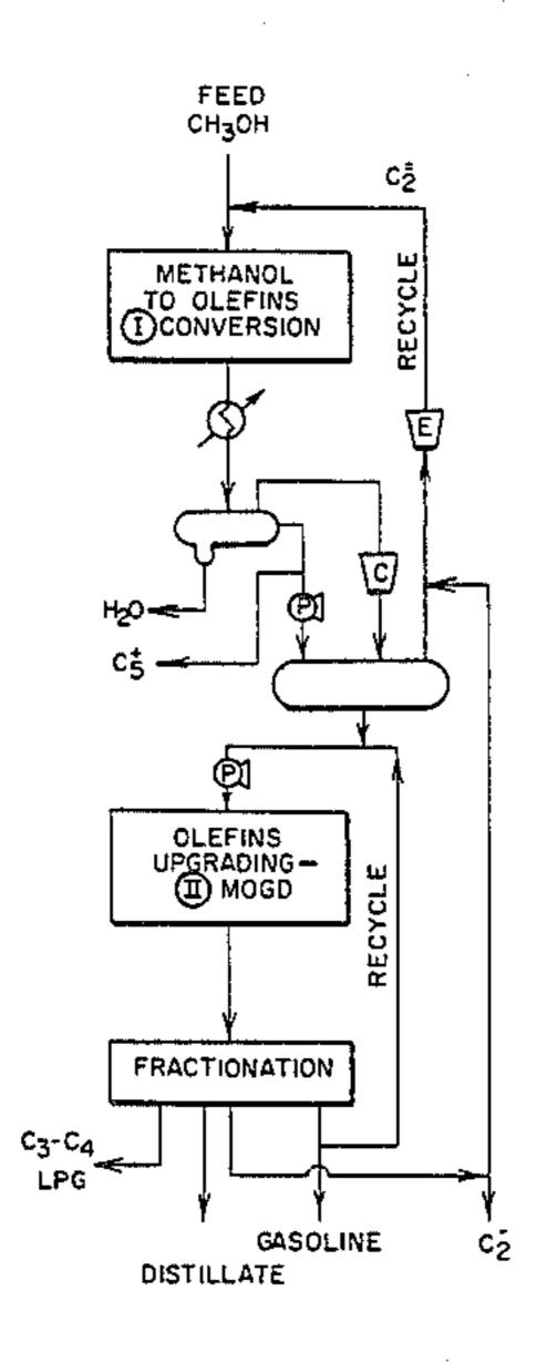
FEED CH<sub>3</sub>OH CŽ METHANOL **OLEFINS** YCL FRACTIONATION GASOLINE
