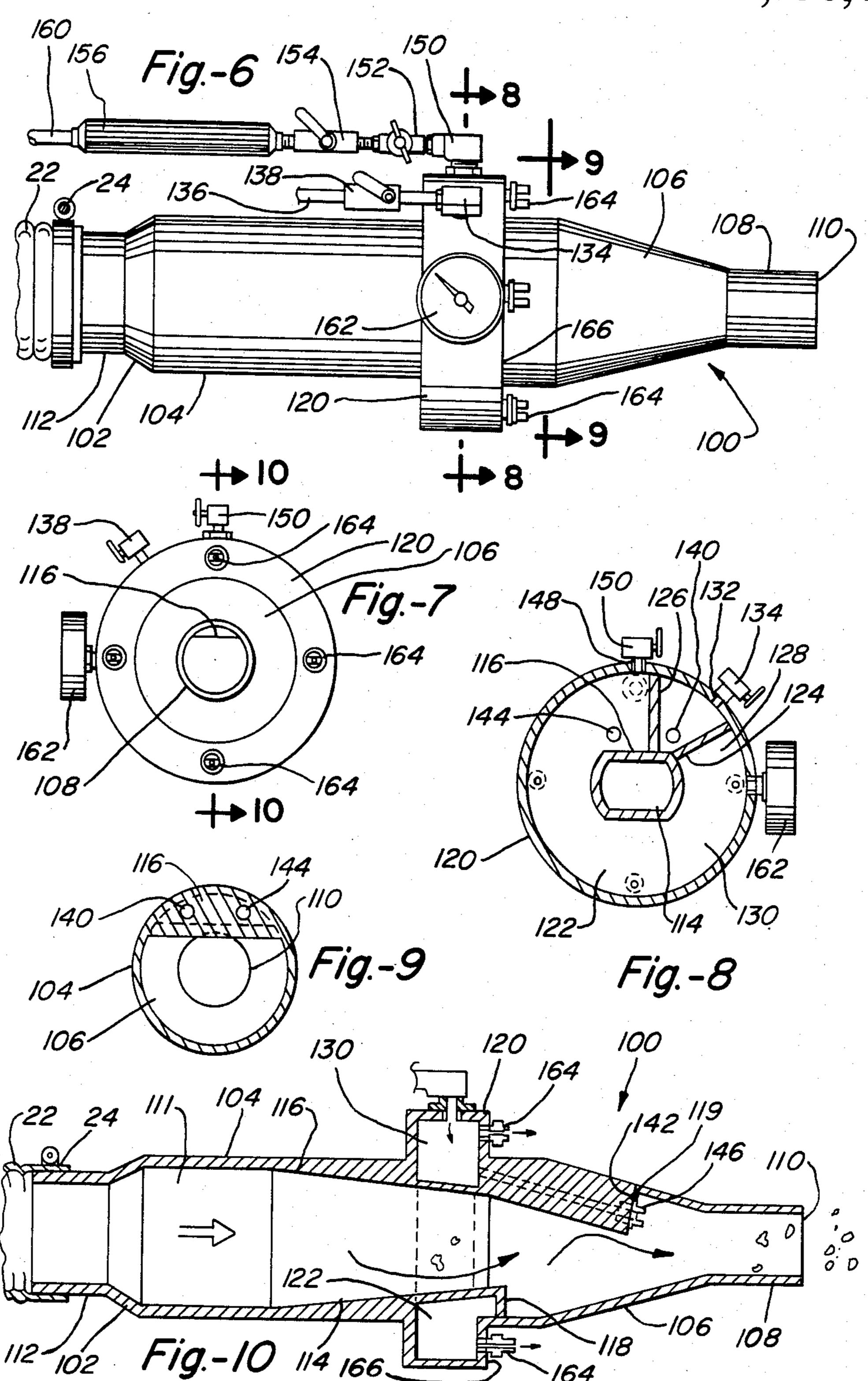
REDUCED FIBER INSULATION NOZZLE
