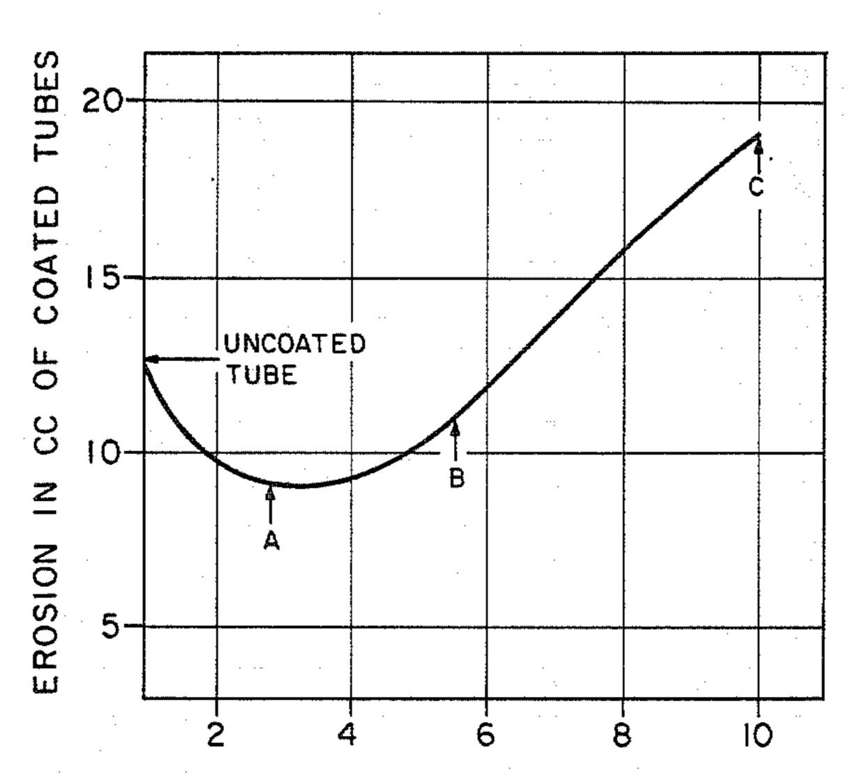
COLLOIDAL SILICA CONTENT OF COATING,%
