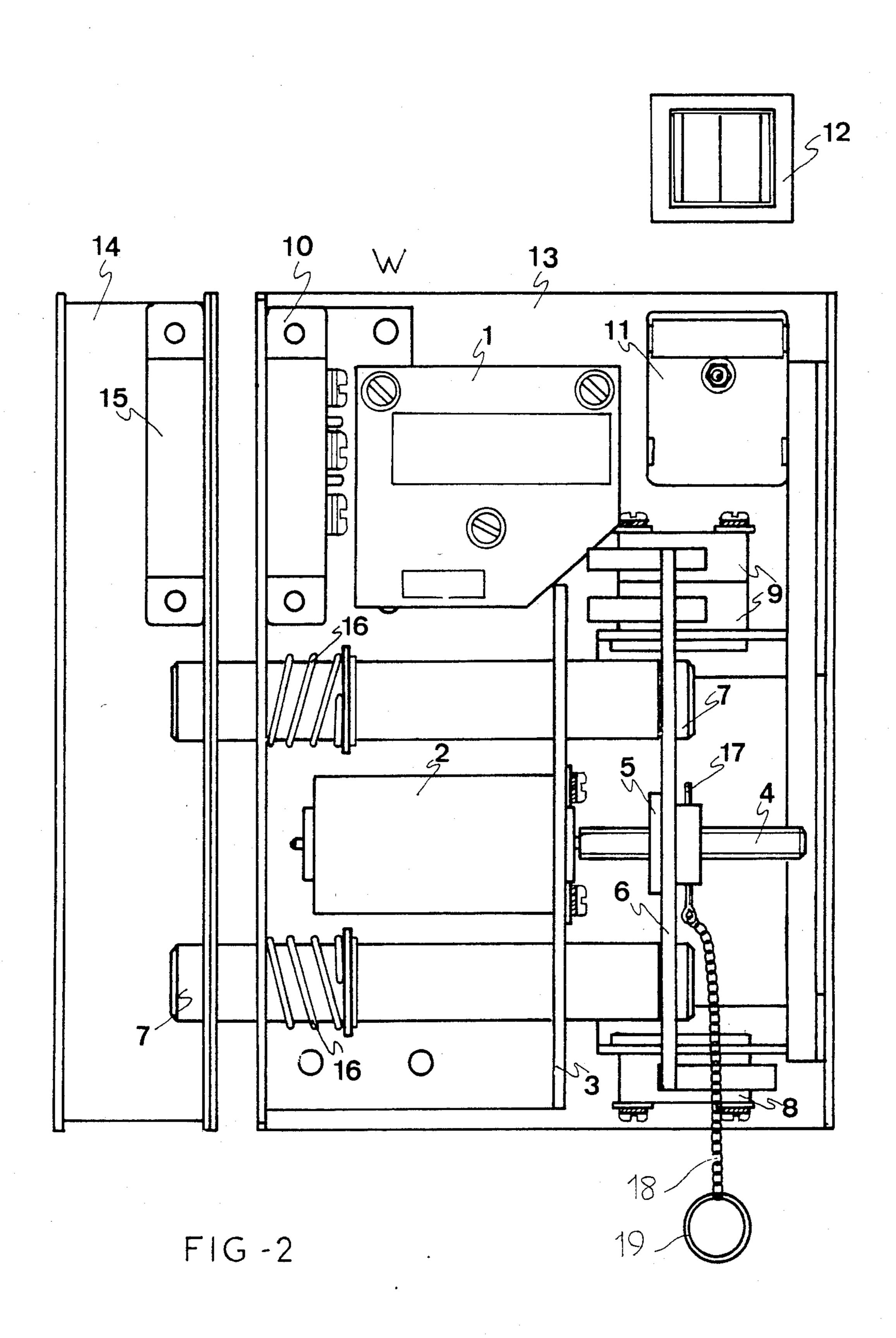
ELECTRONICALLY MOTORIZED LOCK WHOSE MOTOR SHAFT IS PARALLEL TO THE LONGITUDINAL AXIS OF THE BOLTS
