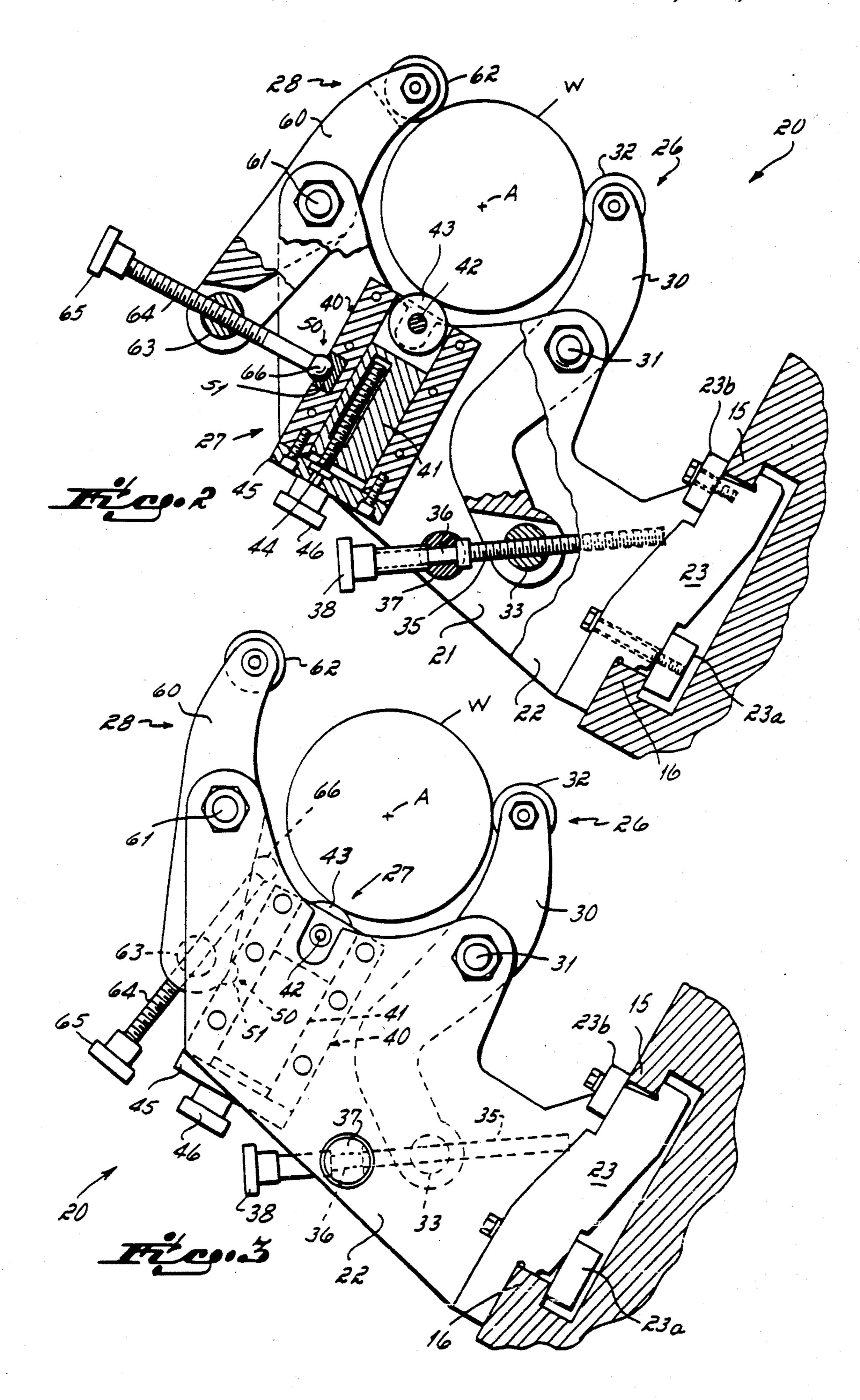
STEADYREST FOR SLANT BED LATHE
