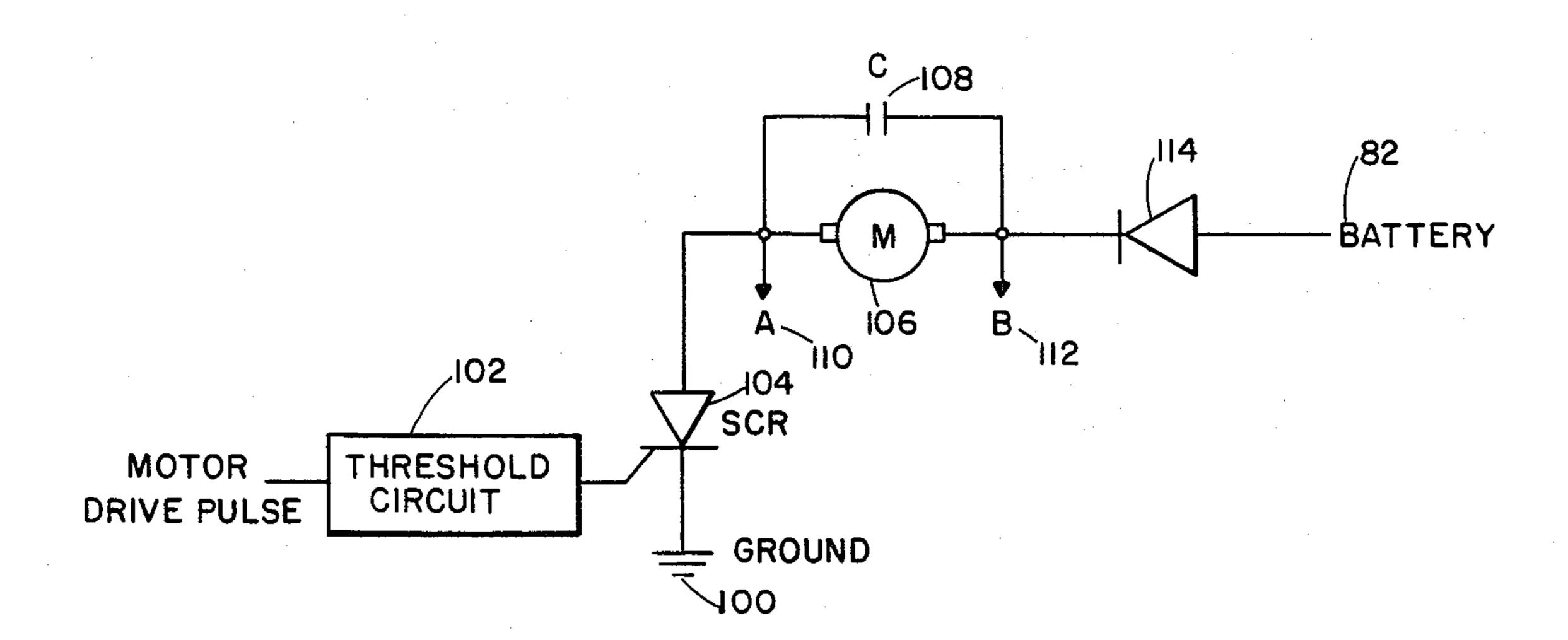
FIG. 5. MOTOR DRIVE CIRCUIT.
