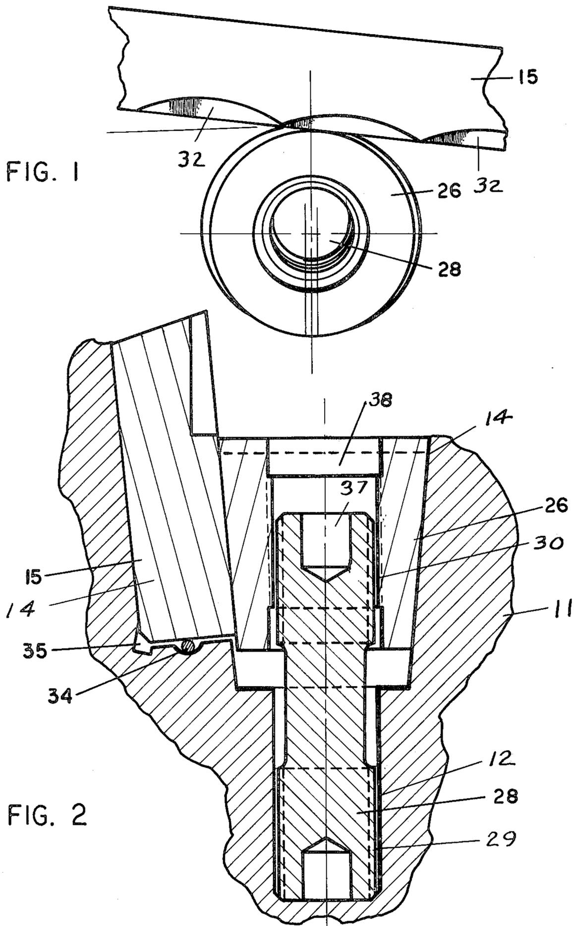
CONICAL WEDGE LOCK FOR CUTTER BLADE
