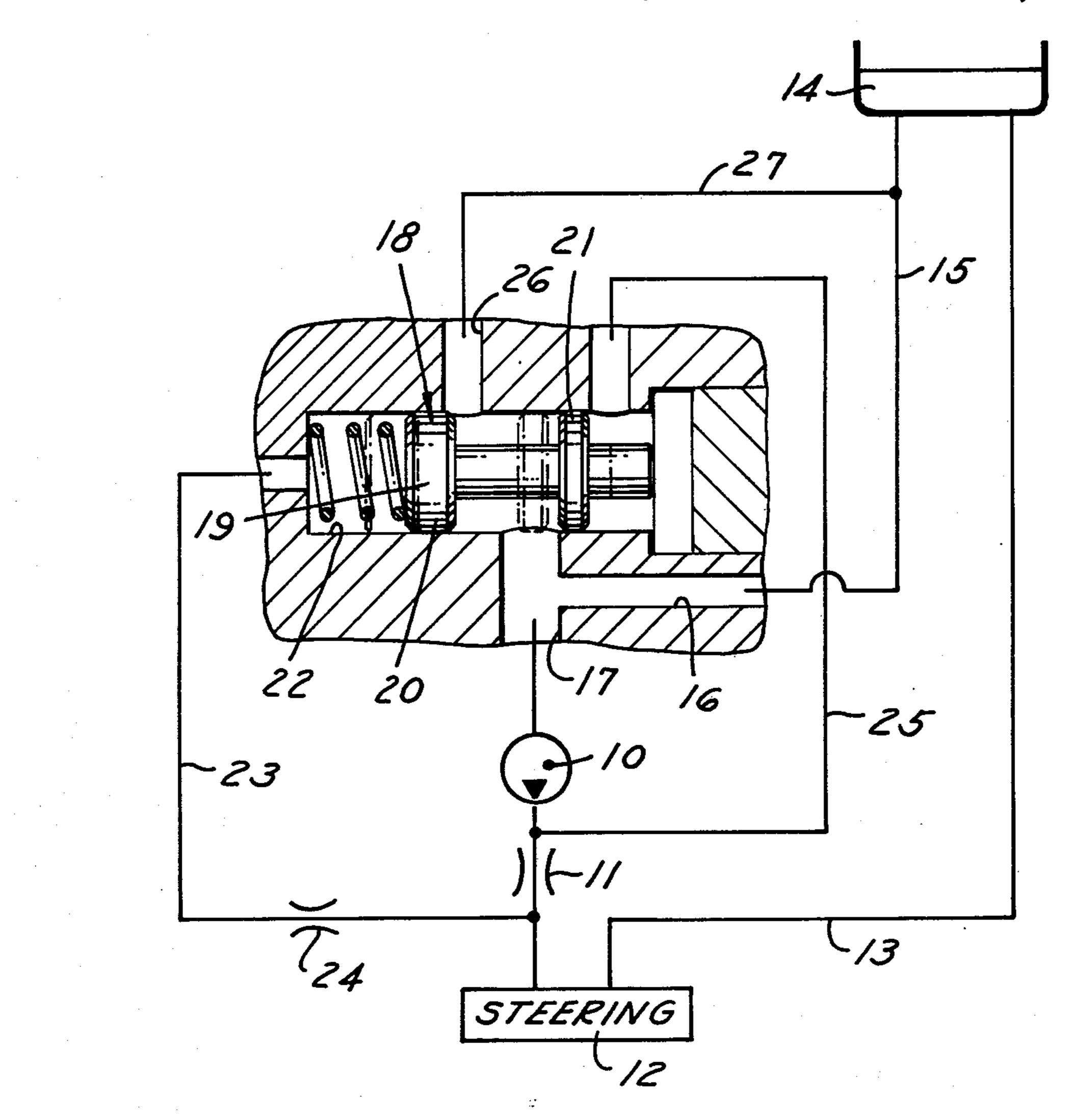
PUMP WITH INLET PASSAGES DOWNSTREAM
