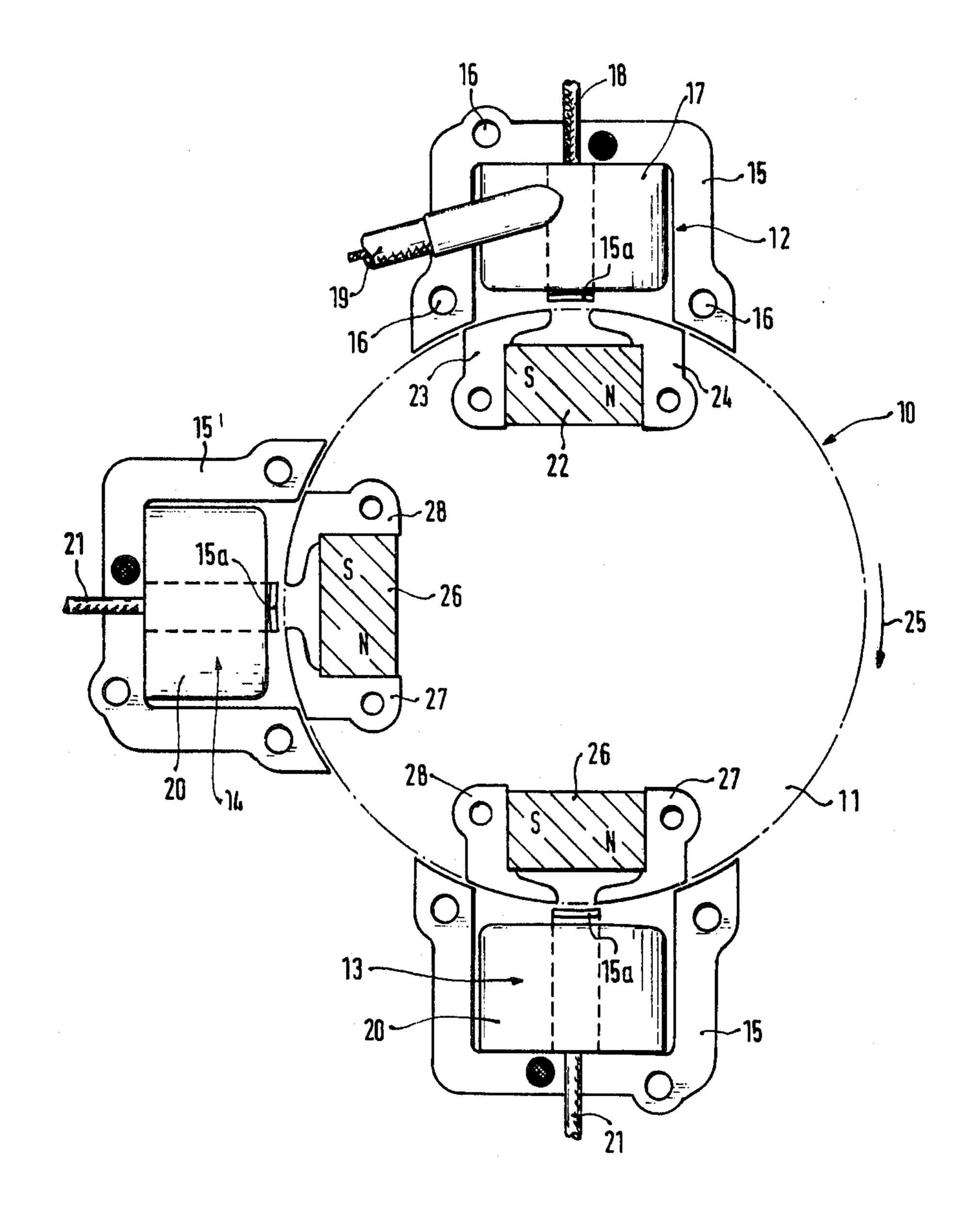
MAGNETO GENERATOR FOR A CONTACTLESS **IGNITION SYSTEM**
