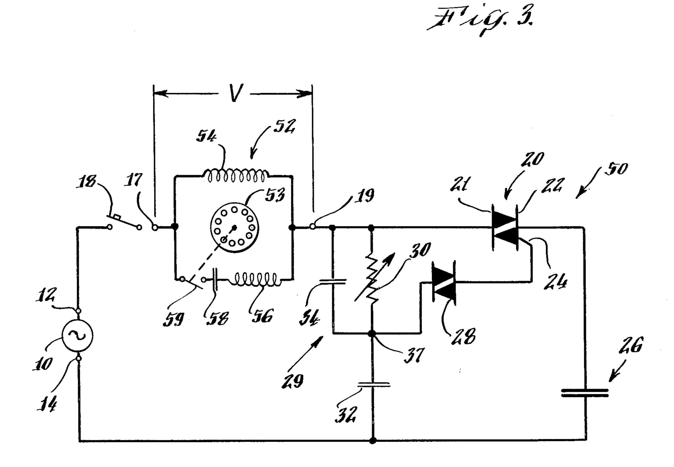
MOTOR SPEED CONTROL CIRCUIT PROVIDING
