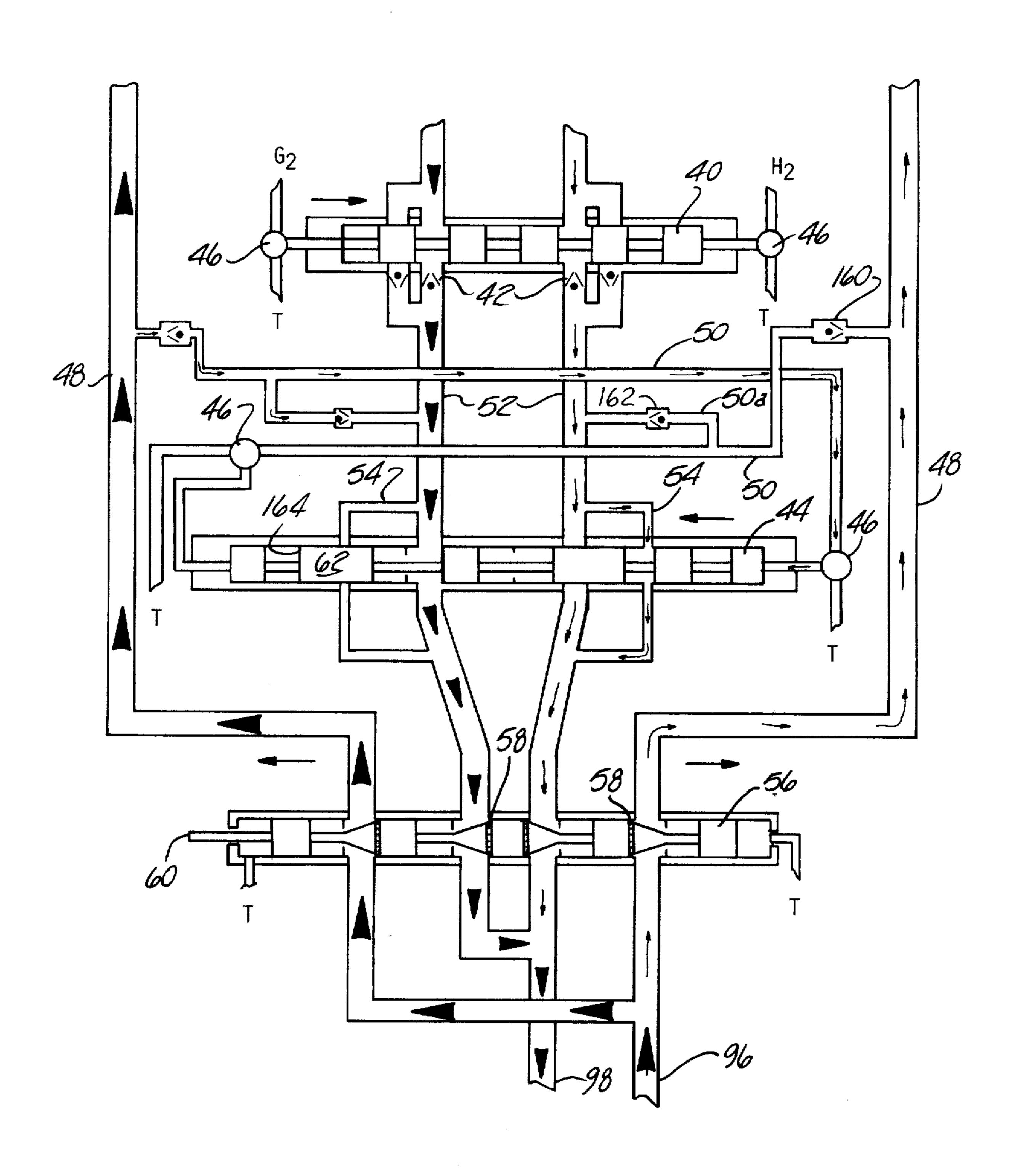
Fig-48 SECOND POSITION RIGHT WHEEL SPIN
