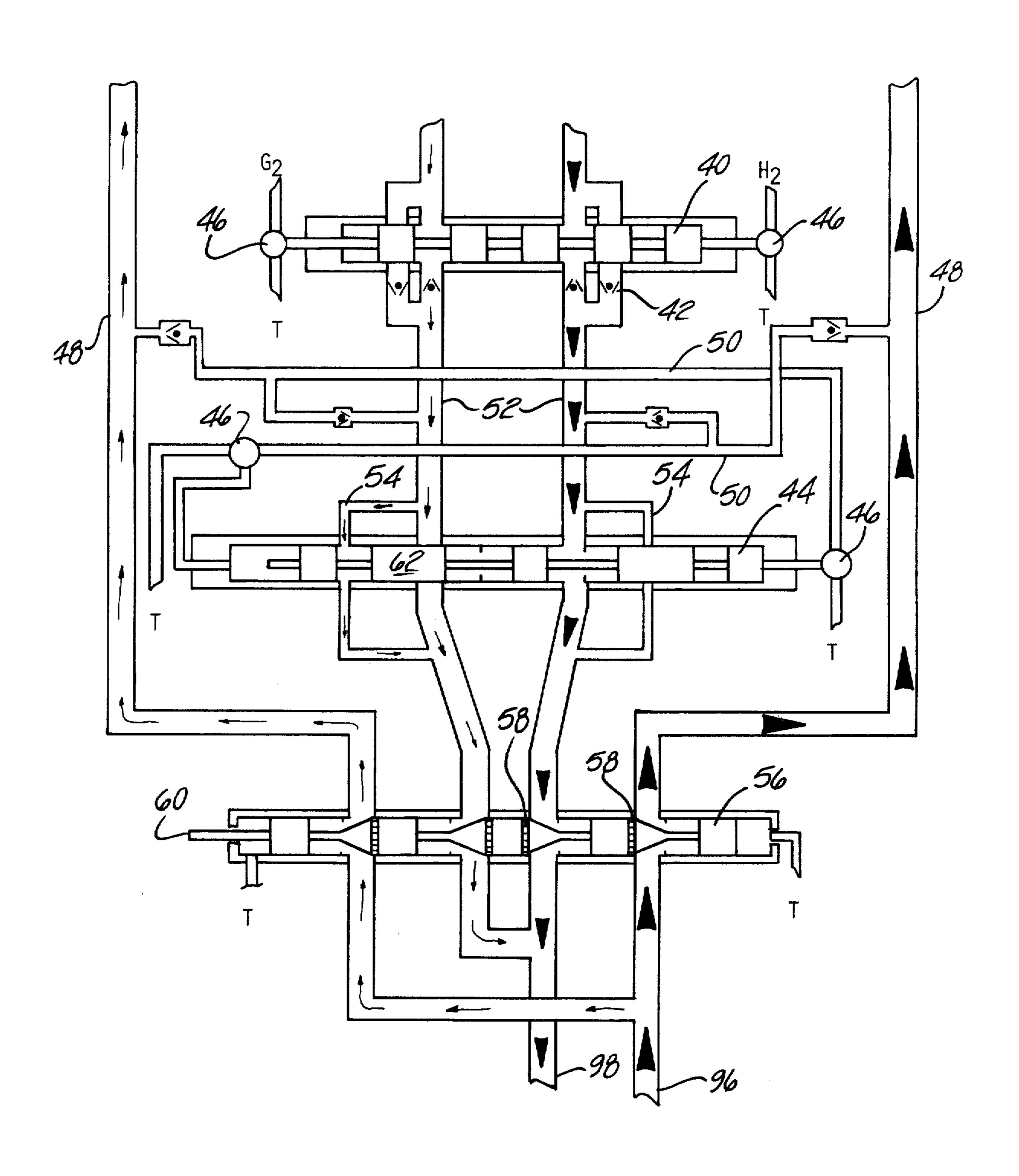
Fig-3B LOW POSITION LEFT WHEEL SPIN
