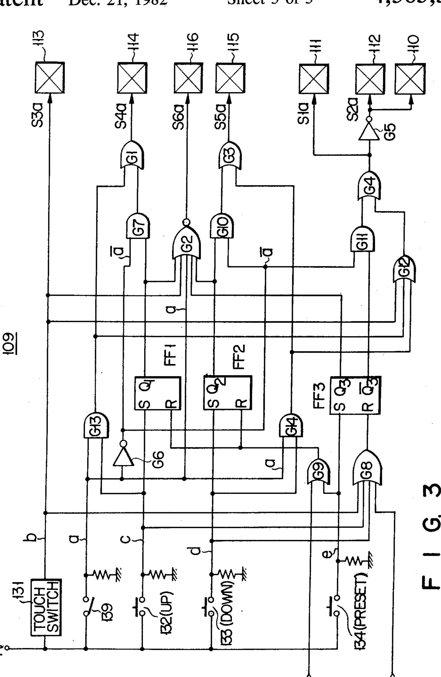
RADIO RECEIVER HAVING PHASE LOCKED LOOP AND AUTOMATIC FREQUENCY CONTROL LOOP FOR STABLY MAINTAINING LOCAL OSCILLATOR FREQUENCY OF VOLTAGE-CONTROLLED LOCAL OSCILLATOR
