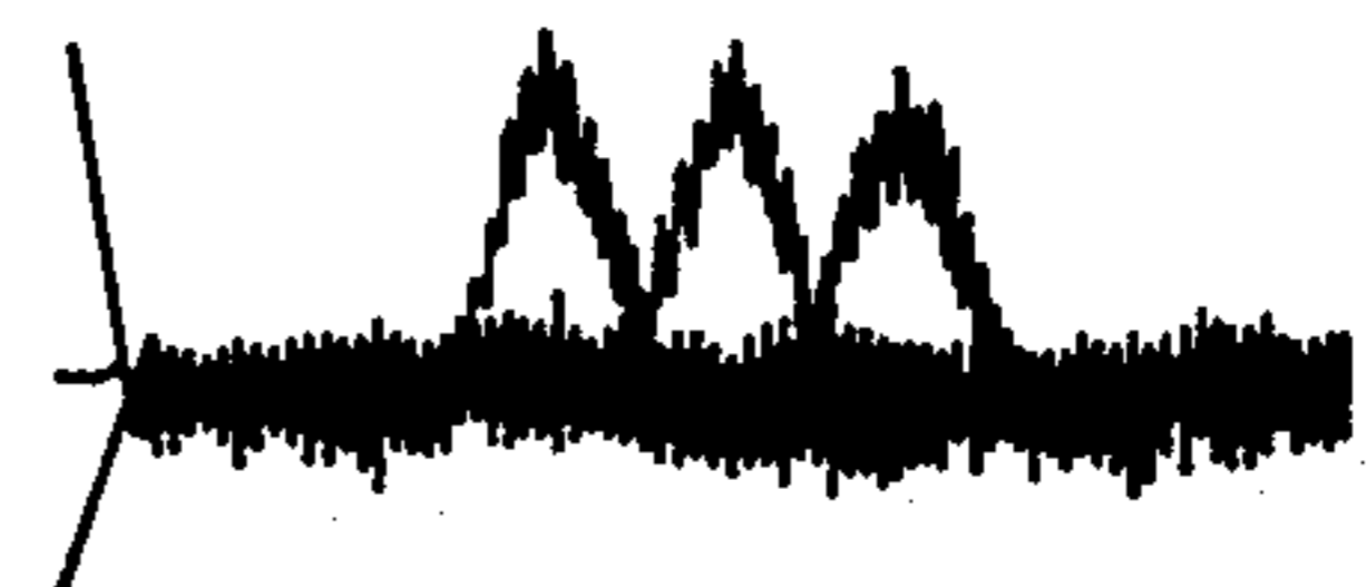
PULSE 1 : 110 ns (260 ns) DELAY PULSE 2 : NO DELAY PULSE 3 : 110 ns (260 ns) ADVANCE
