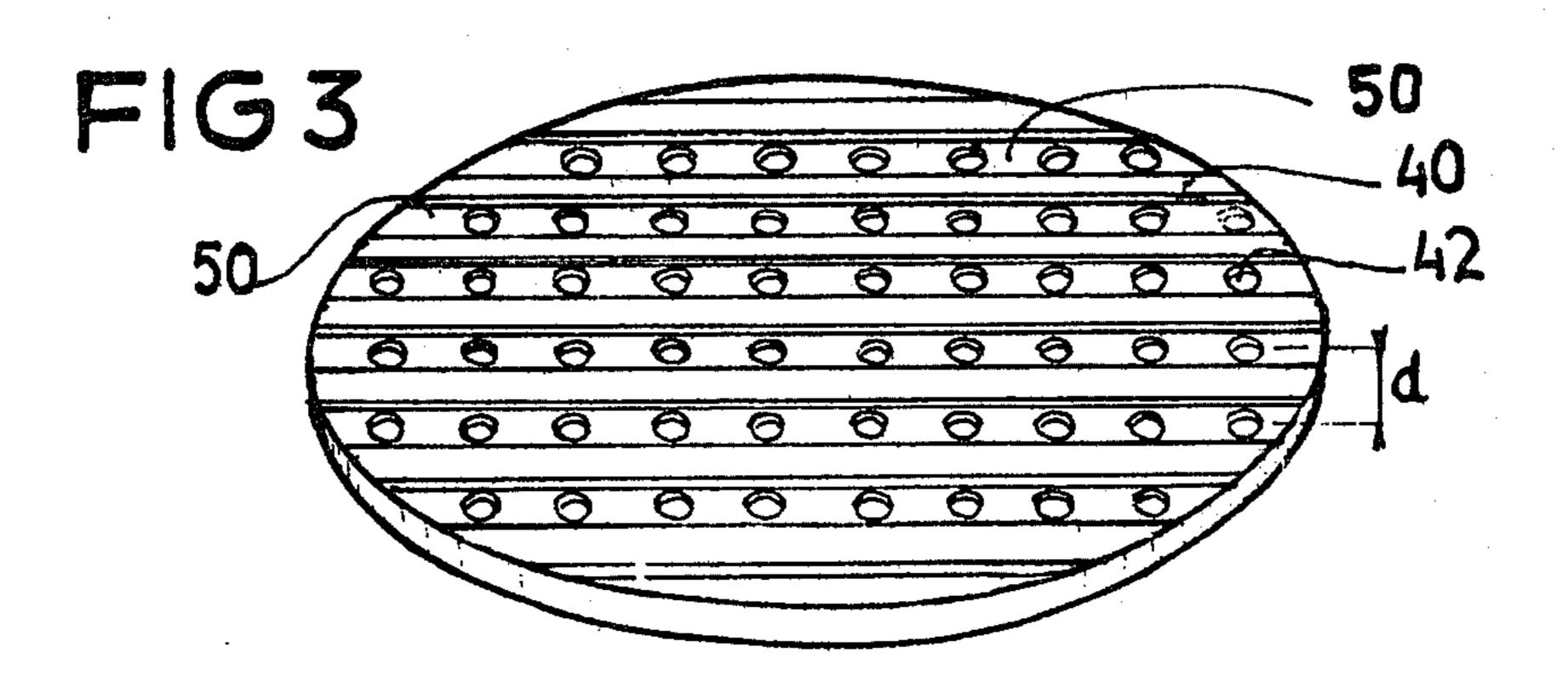
FILTER FOR PURIFYING A FLUID CONTAINING FERROMAGNETIC PARTICLES
