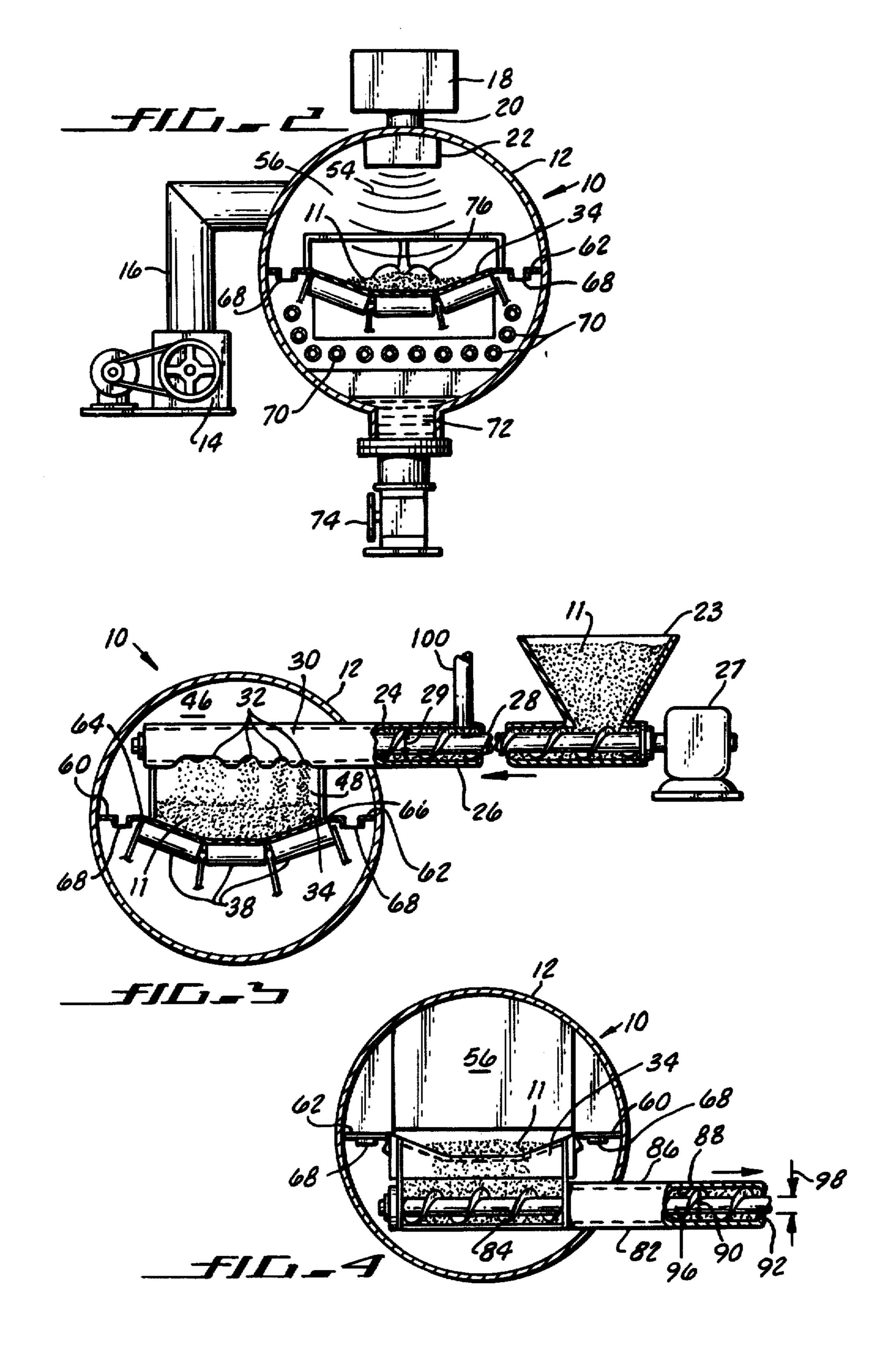
MICROWAVE HEATED VACUUM DRYER FOR **POWDERS**
