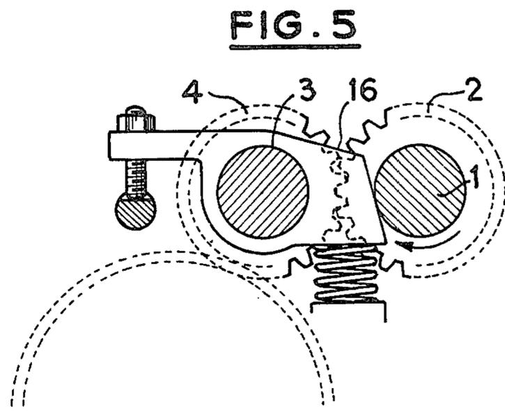
**GEARBOX COMPRISING MEANS FOR BRAKING
