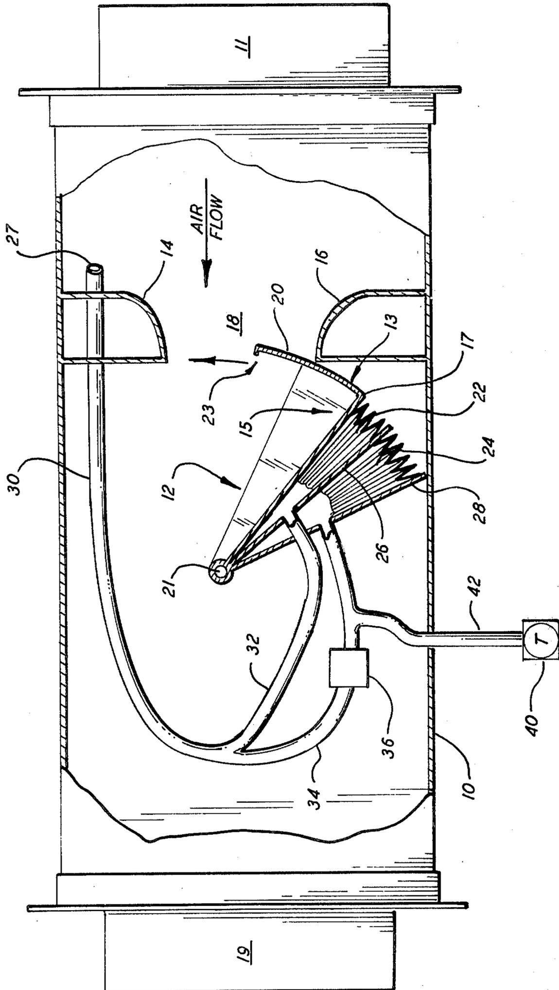
**SYSTEM POWERED DAMPER BLADE
