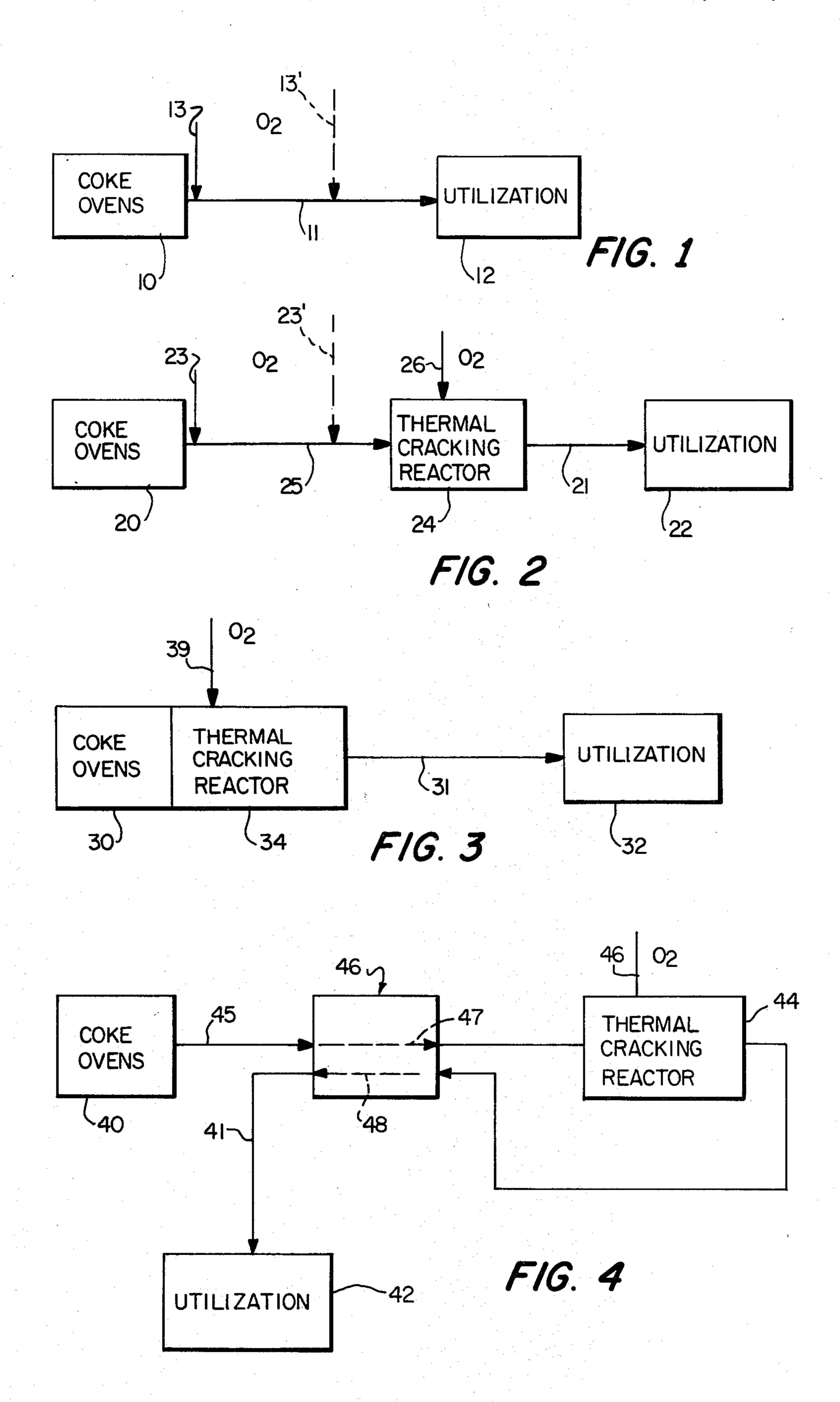
PROCESS FOR CONVEYING HOT CRUDE COKE OVEN GAS FROM COKE OVENS TO A POSITION OF UTILIZATION WHILE PREVENTING CONDENSATION OF HIGHER HYDROCARBONS 5
