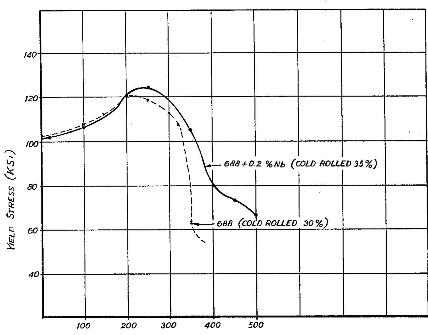
HEAT TREATMENT TEMPERATURE FOR 1 HOUR (°C)
