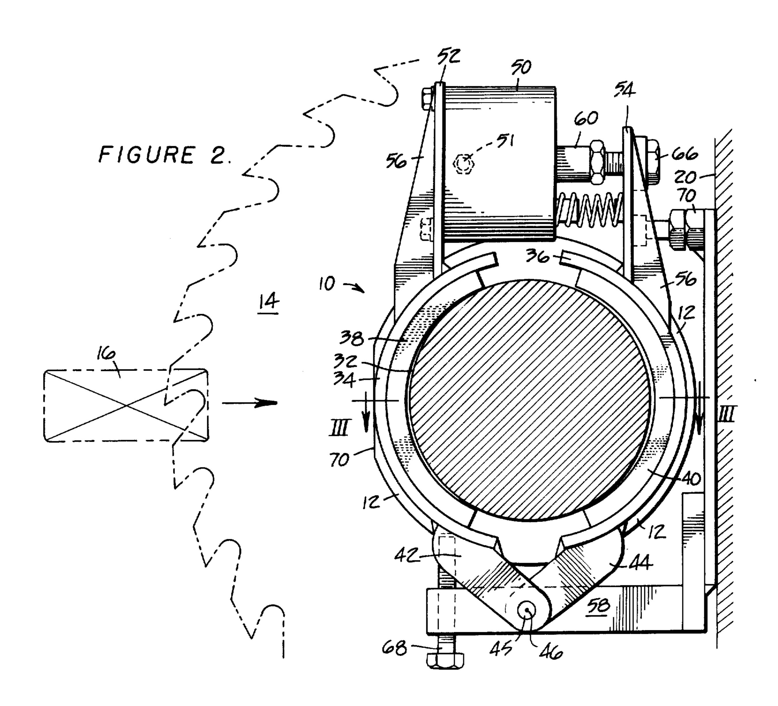
BRAKE APPARATUS FOR A MOTOR DRIVEN SAW BLADE
