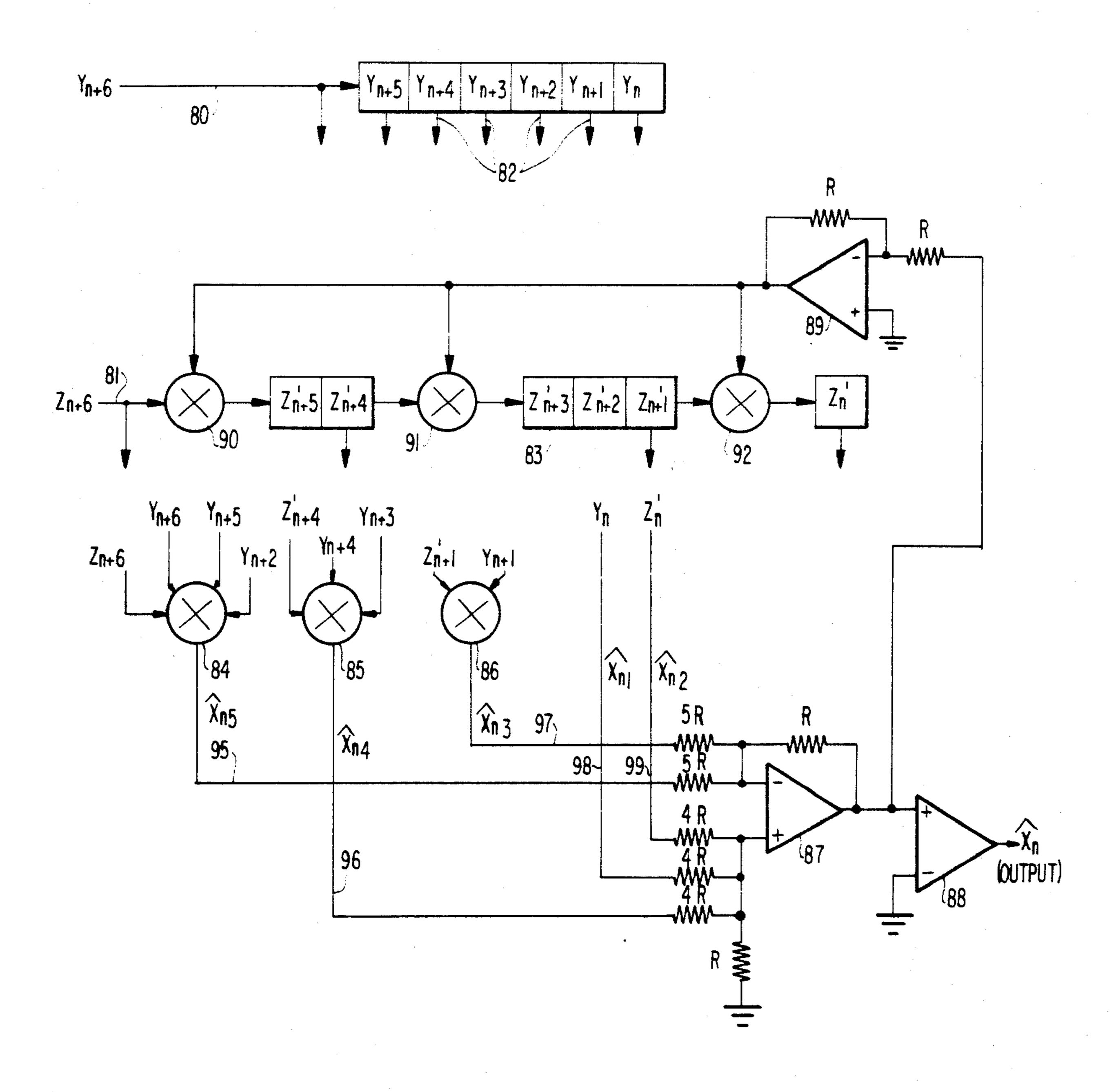
FIG 5 RATE 1/2 DECODER TYPE II
