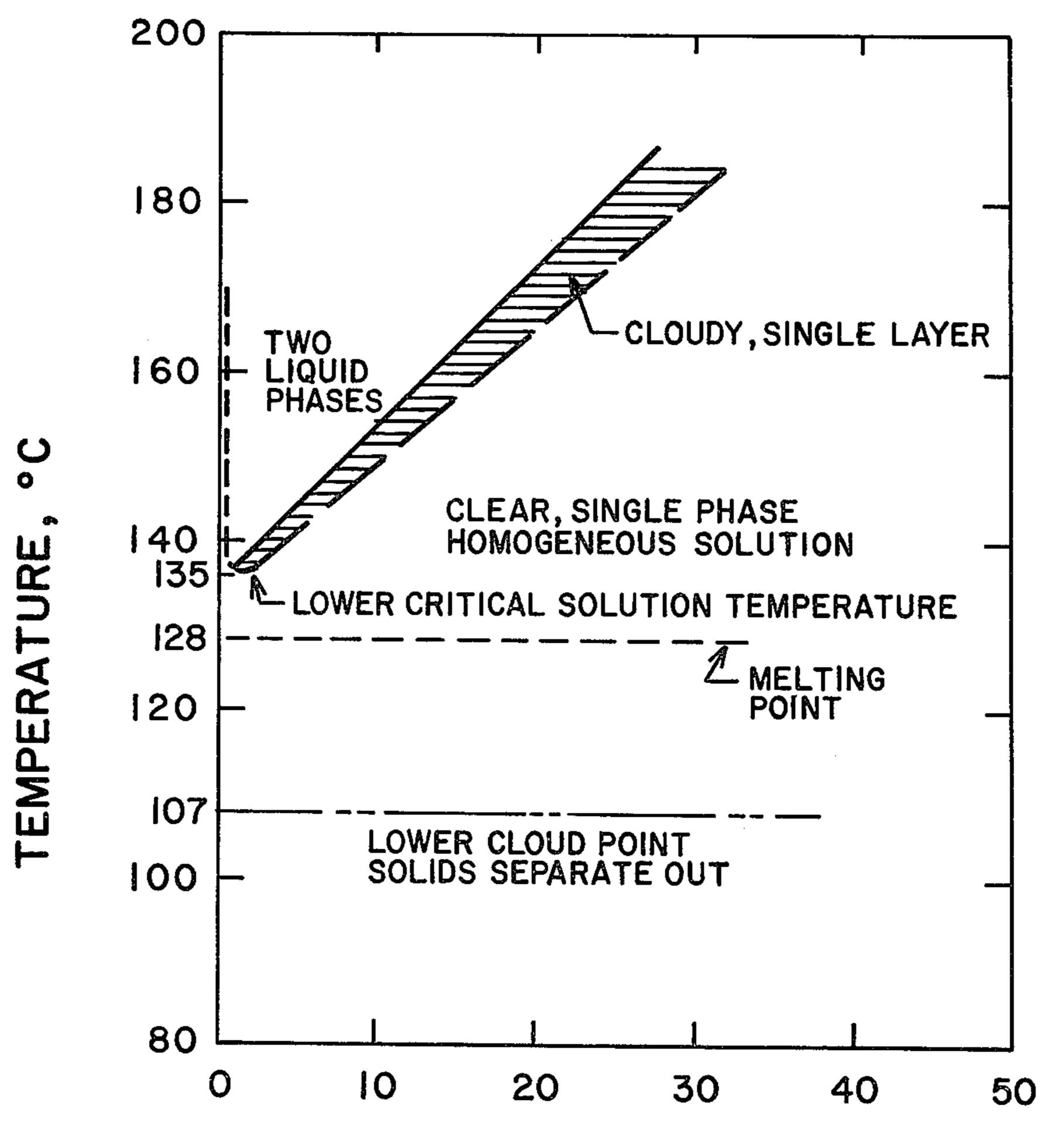
HIGH - DENSITY POLYETHYLENE - WEIGHT % LIQUID IS N-HEXANE
