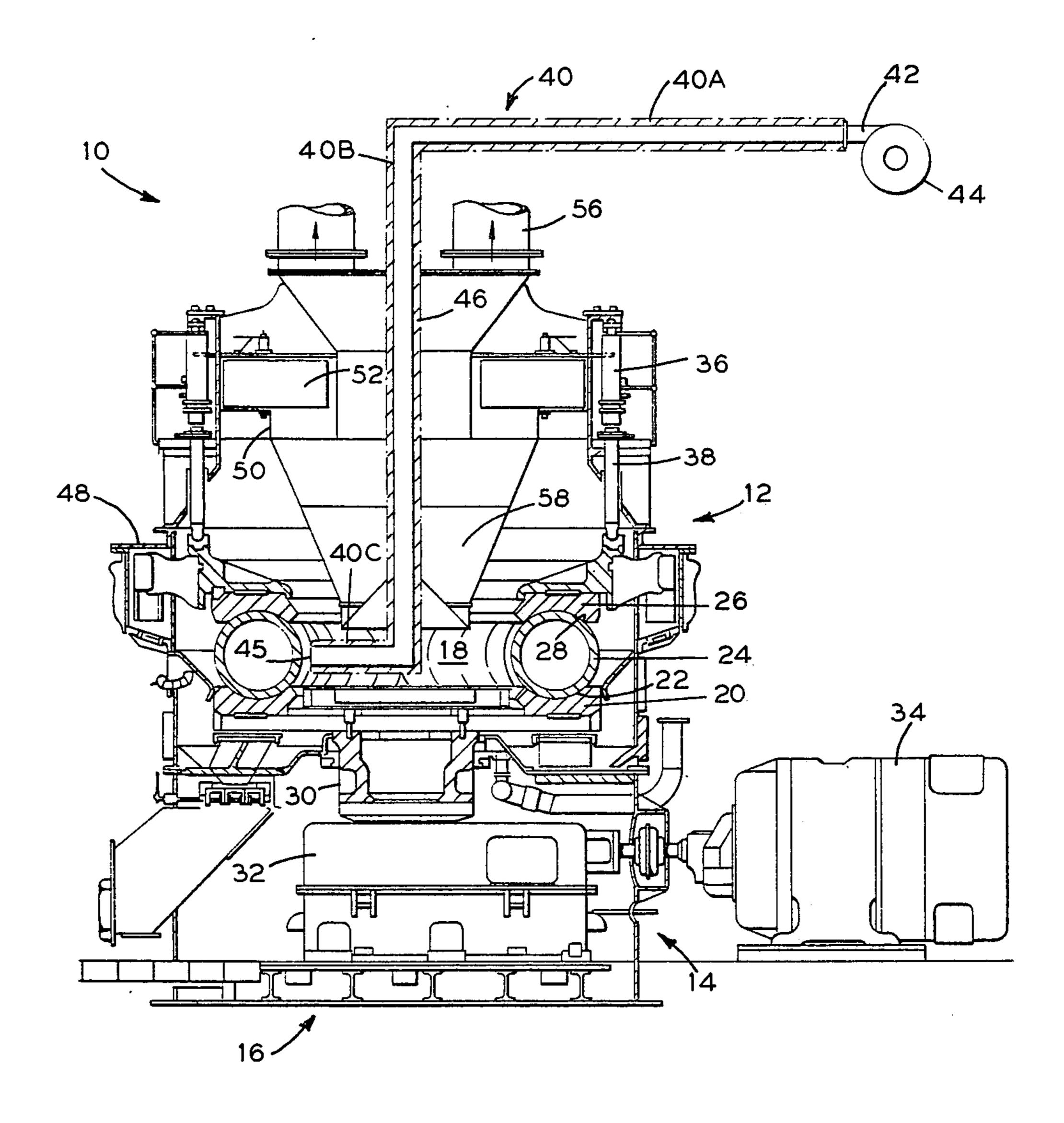
**COAL SLURRY DRYING APPARATUS**
