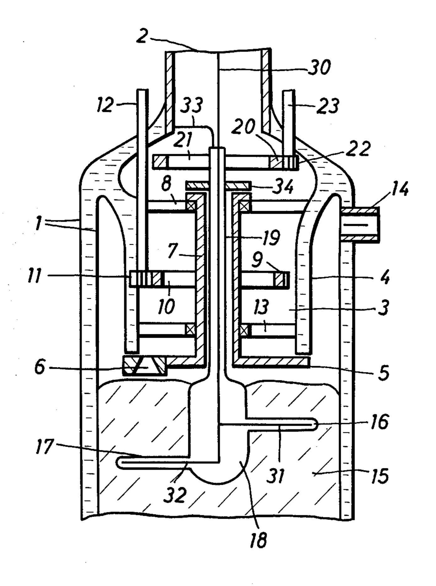
REACTOR FOR GASIFYING SOLID FUELS, PARTICULARLY COAL, UNDER SUPERATMOSPHERIC PRESSURE
