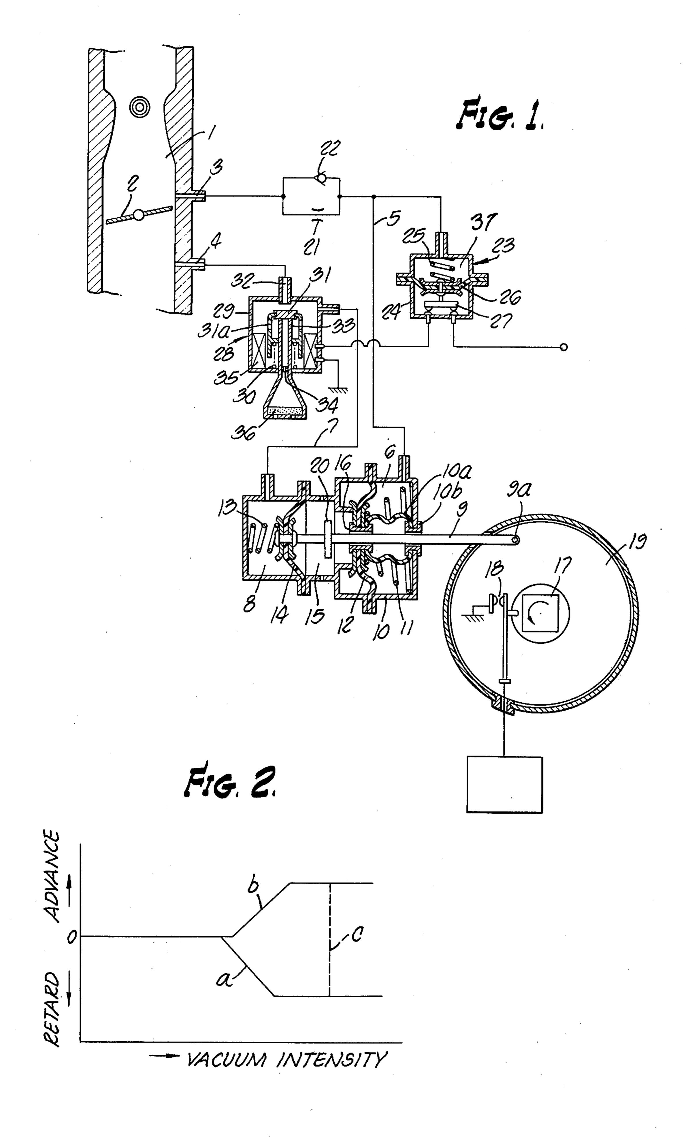
CONTROL SYSTEM FOR ENGINE IGNITION TIMING
