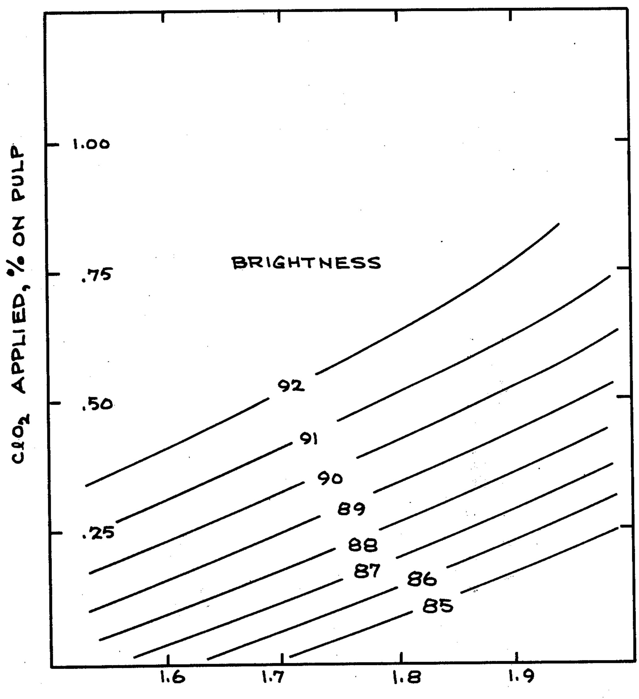
R2/R1 MEASURED ON WASHED EH STAGE PULP
