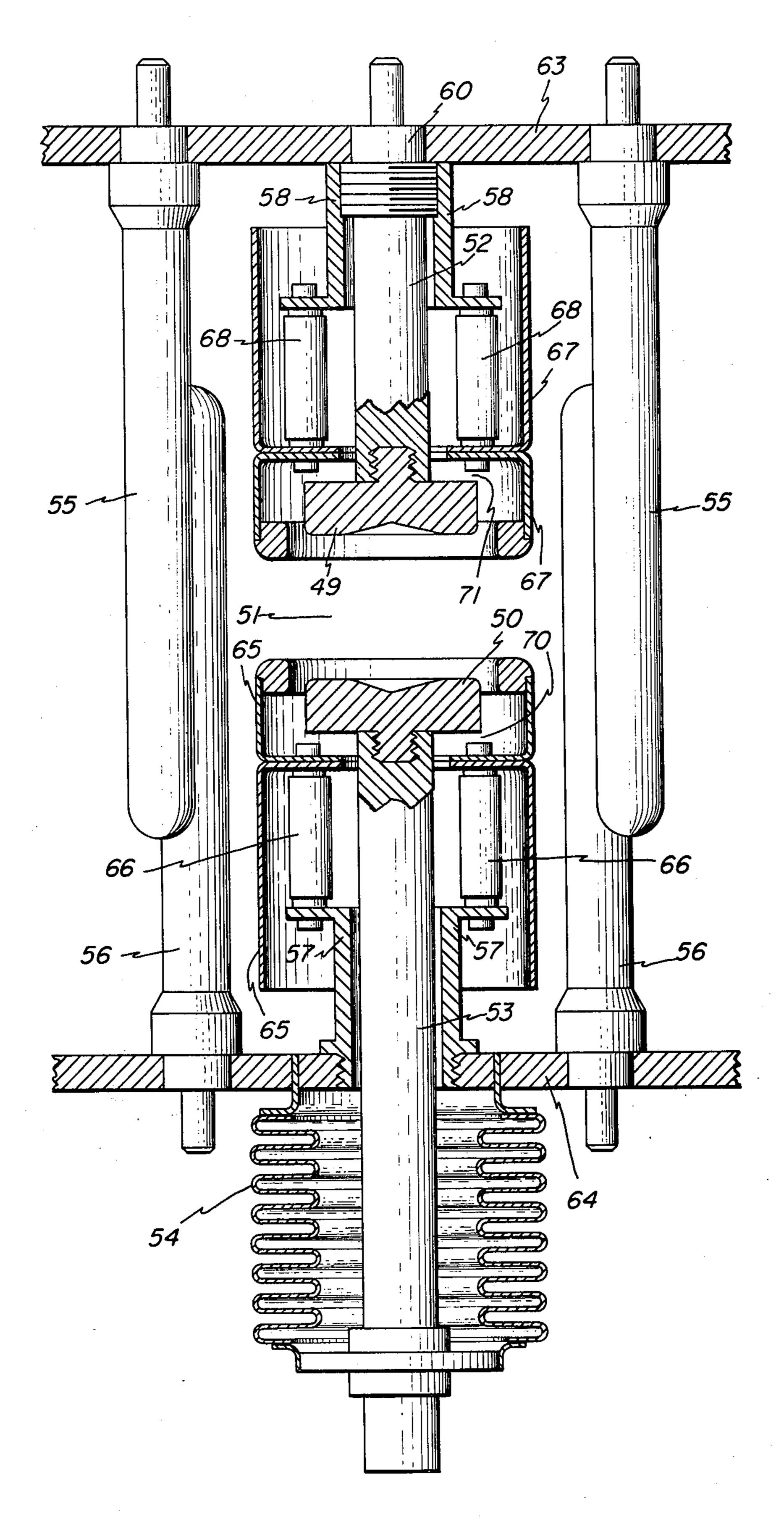
VACUUM INTERRUPTER WITH PRIMARY ELECTRODE SURROUNDED BY HIGH DIELECTRIC STRENGTH SHIELD
